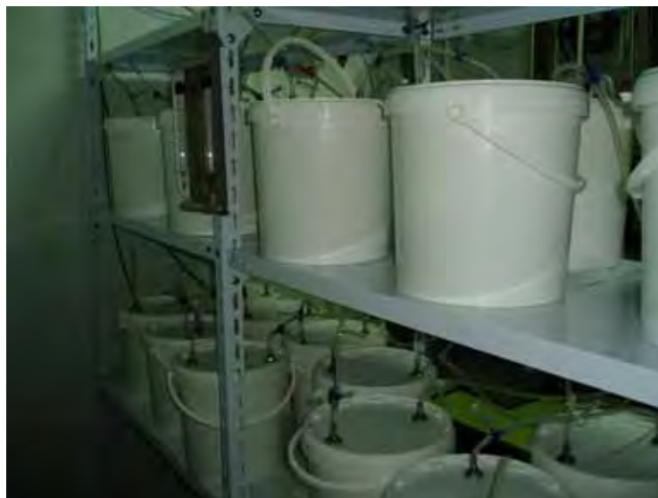
Figura 4. Aplicação da atmosfera controlada em potes plásticos (5% O 2 :5% CO 2 e 5% O 2 :1% CO 2 ).
