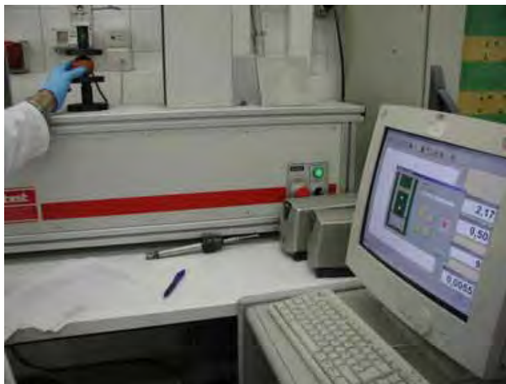
Figura 8. Medição da firmeza dos tomates através da deformação em prensa.
