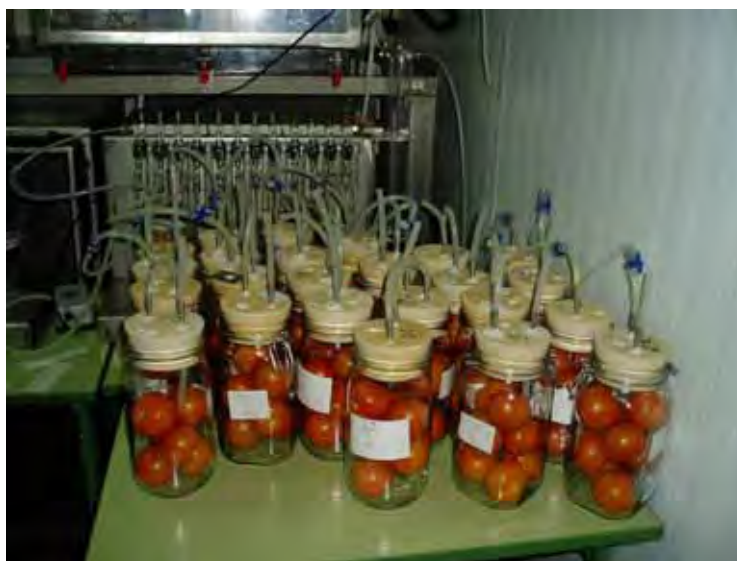
Figura 5. Aplicação da atmosfera controlada em potes de vidro (ar).
