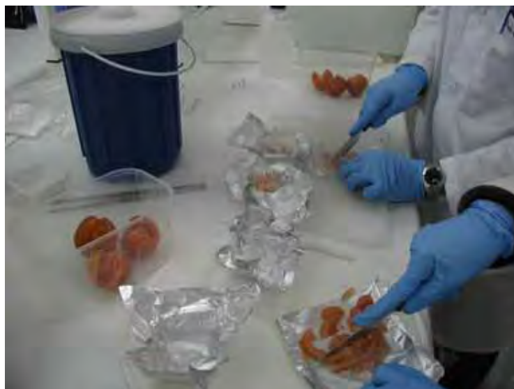
Figura 7. Aplicação de N 2 líquido sob as amostras de tomate.
