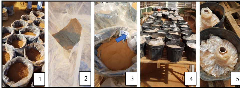
Figura 1. Processo de incubação dos solos, em vasos, durante um período de 60 dias: 1- Enchimento dos vasos e pesagem; 2- Aplicação do pó de rocha de basalto; 3- Adição de água deionizada até 70% da capacidade de campo; 4- Vasos na bancada e; 5- Procedimento para trocas gasosas. UNESP, Jaboticabal-SP, 2020.
