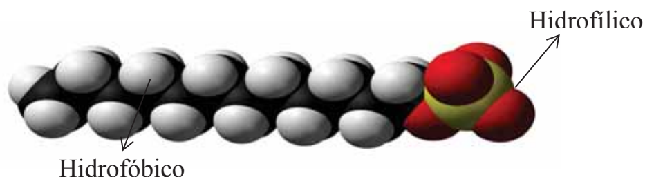
Figura 2.1- Representação de uma molécula de surfactante.
