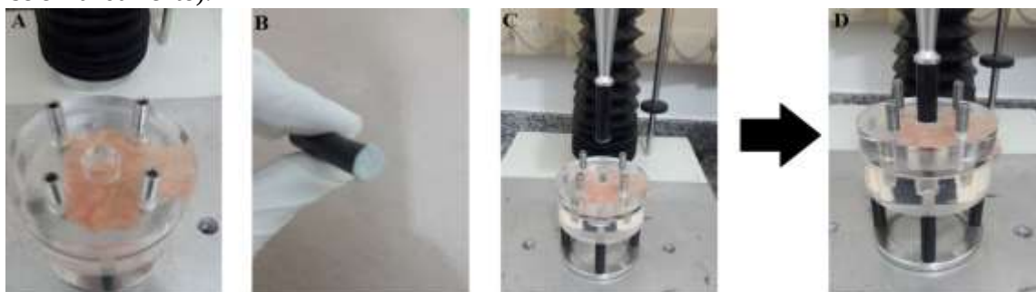
Figura 11. Esquema ilustrativo da metodologia utilizada no ensaio de mucoadesão (A- disposição do tecido no suporte, B- amostras fixadas à sonda, C- sistema montado para a análise e D- análise em andamento).
