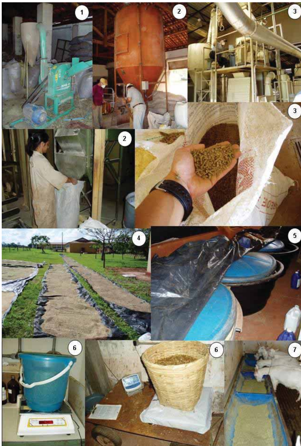
Figura 1B. Picadora utilizada na moagem do Capim-limão (1); Mistura da dieta na Fábrica de ração da FZEA/USP (2); Peletização da dieta na Fábrica de ração da FCAV/UNESP (3); Secagem dos “pellets” (4); Armazenamento (5); Pesagem diária da dieta (6); Fornecimento aos animais (7).
