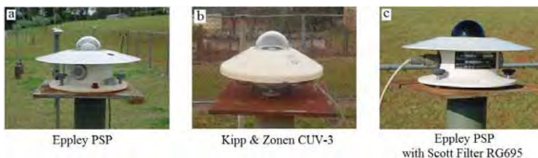
Figura 3. Sensores: (a) piranometro Eppley PSP; (b) radiometro CUV-3 Kipp & Zonen; (c) piranometro Eppley PSP com cúpula seletiva.
