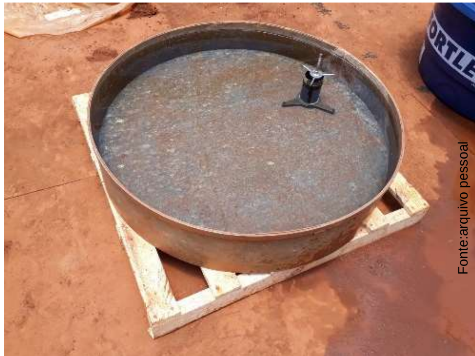
Figura 2 – Tanque Classe A, Instalado no local da pesquisa
