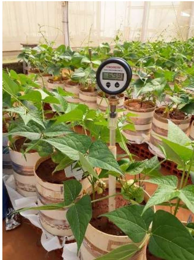
Figura 6 – Tensiômetros de punção e tensímetro digital para manejo da irrigação
