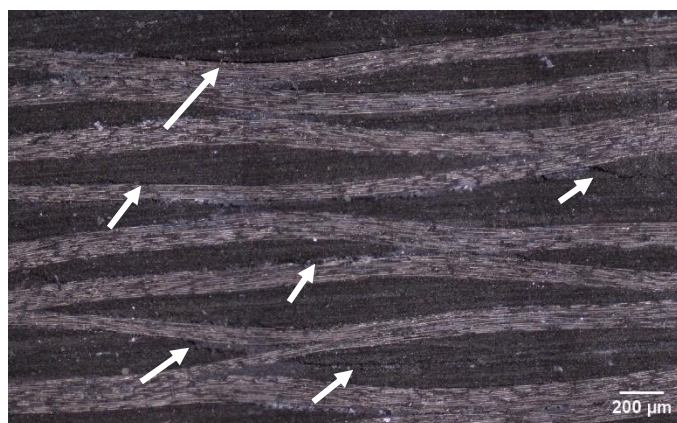
Figura 86 – Fractografia do compósito CF1 [0] 18 .
