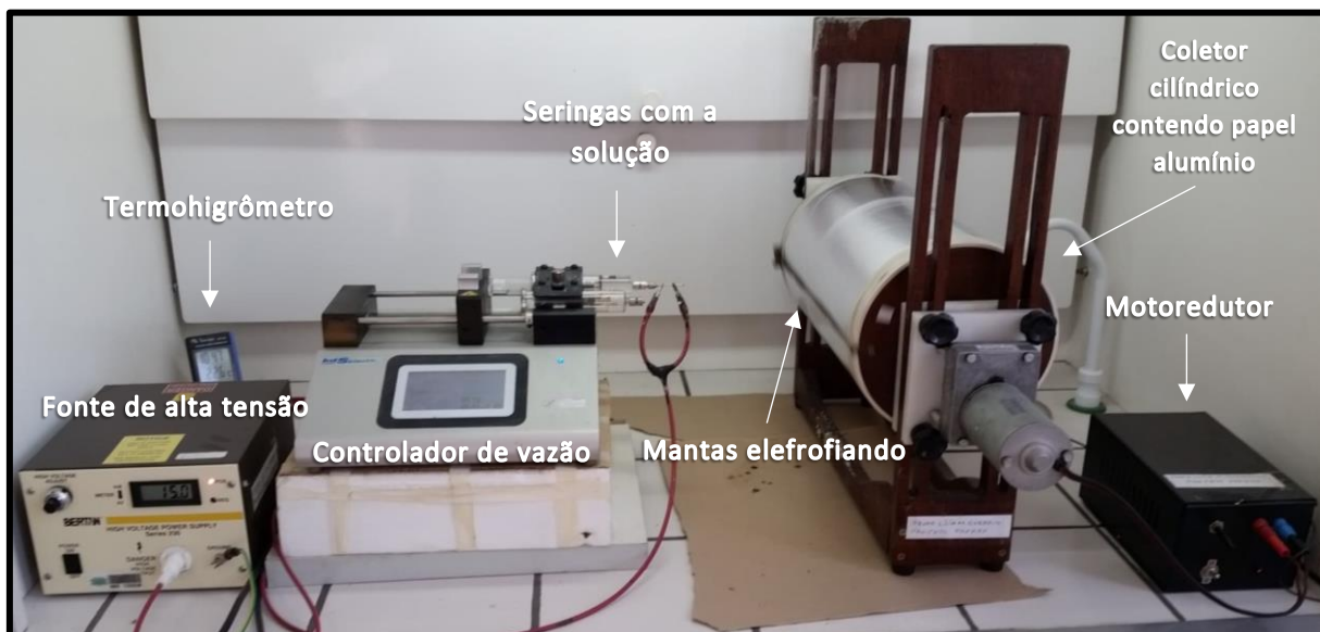
Figura 14 – Equipamento de eletrofiação localizado na UNIFESP (São José dos Campos).
