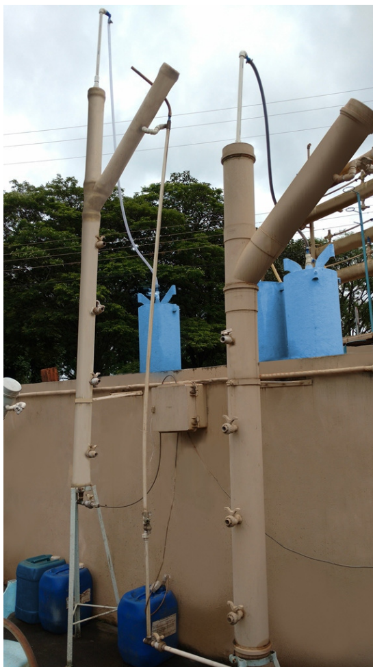
FIGURA 5. Foto do sistema de tratamento da co-digestão anaeróbia de águas residuárias da bovinocultura de leite e do despolpamento de frutos do cafeeiro em dois reatores anaeróbios de alta taxa com manta de lodo e fluxo ascendente (UASB) - R1 e R2 e seus respectivos gasômetros.
