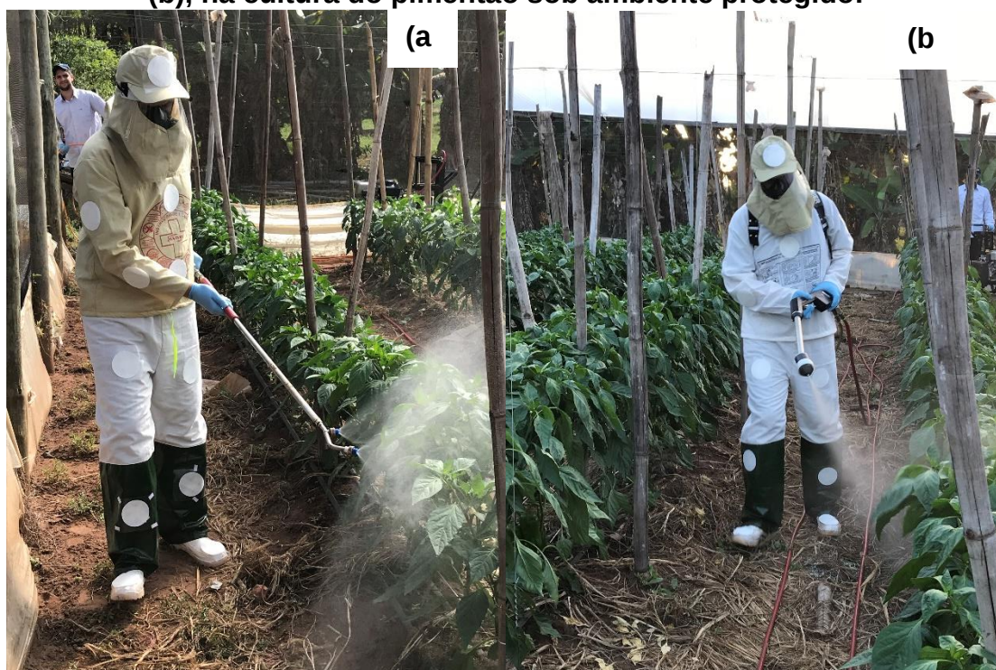
Figura 1 - Avaliação da exposição dérmica do operador aos produtos fitossanitários com pulverizador hidráulico (a) e pneumático com eletrostática (b), na cultura do pimentão sob ambiente protegido.
