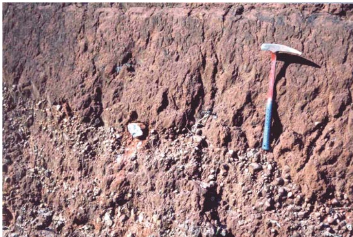
Foto 14 Detalhe do nível de fragmentos de rocha, compostos por quartzitos e basaltos alterados.
