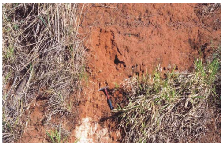
Foto 08 Solo de alteração autóctone da Formação Botucatu. A porção basal mostra a rocha sã (arenito).
