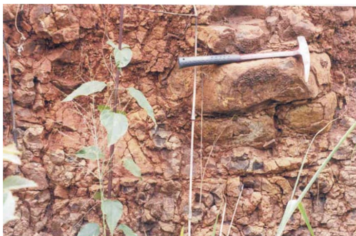
Foto 10 Afloramento de basalto de coloração ocre, parcialmente alterado e intensamente fraturado.
