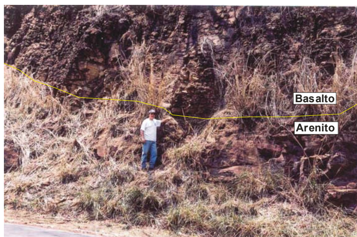
Foto 03 Contato litológico entre o basalto (topo) e o arenito silicificado (base). Feição do sistema intertrapiano.
