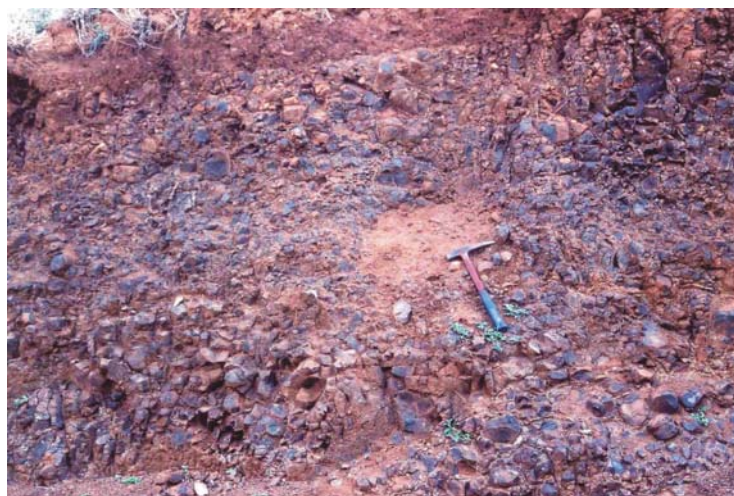
Foto 09 Afloramento de basalto de coloração cinza esverdeado e intensamente fraturado.
