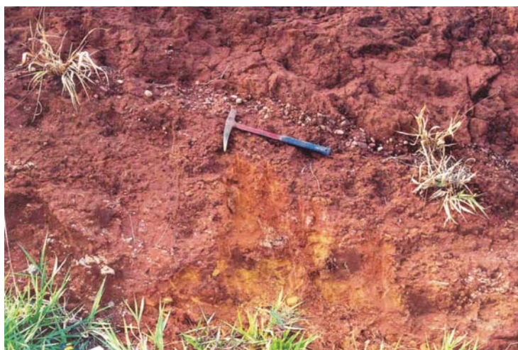
Foto 12 Perfil de solo e saprolito, da base para o topo: basalto saprolítico de coloração ocre amarelada em contato abrupto com nível de fragmentos de rocha e solo de alteração dos sedimentos da Formação Adamantina.
