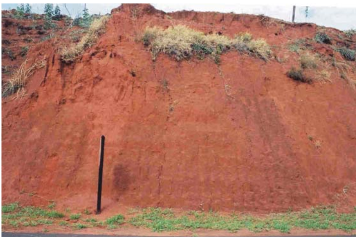
Foto 05 Perfil de solo residual da alteração dos sedimentos silto-arenosos da Formação Adamantina. Latossolo vermelho.
