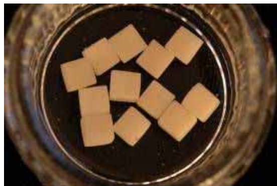
FIGURA 5- Blocos cerâmicos no aparelho sônico.
