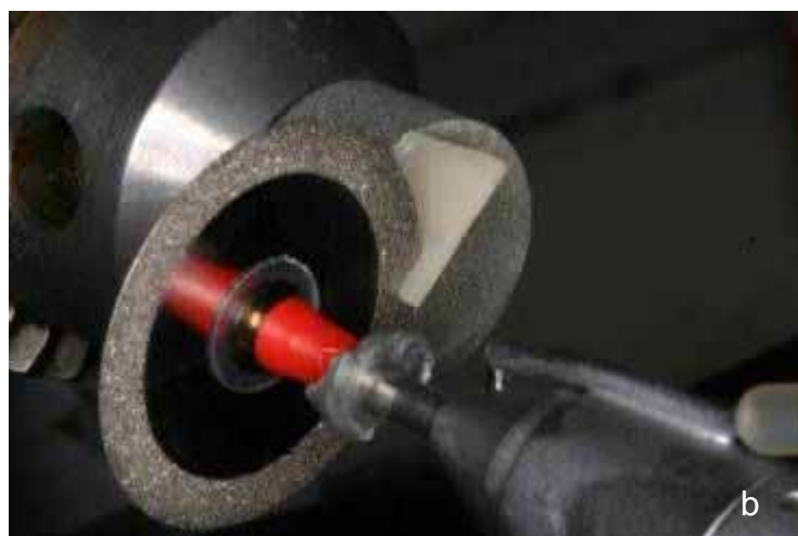
FIGURA 10- Seqüência da preparação dos cp para o ensaio de microtração: a) corte do conjunto bloco cerâmico - cimento resinoso; b) corte da fatia para obtenção das microamostras.
