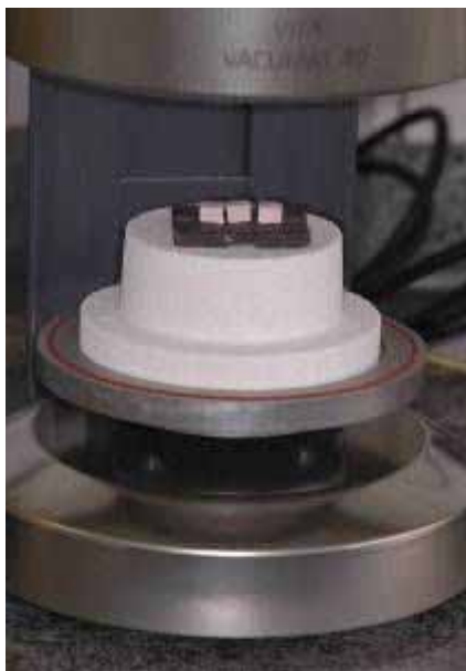
FIGURA 3- Blocos cerâmicos no forno antes da sinterização.
