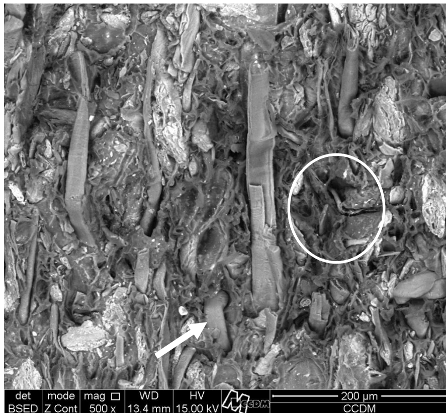
(c) Imagem obtida com elétrons retroespalhados. A seta evidencia uma fibra ancorada na matriz, enquanto o círculo mostra evidências de fibras destacadas da matriz.
