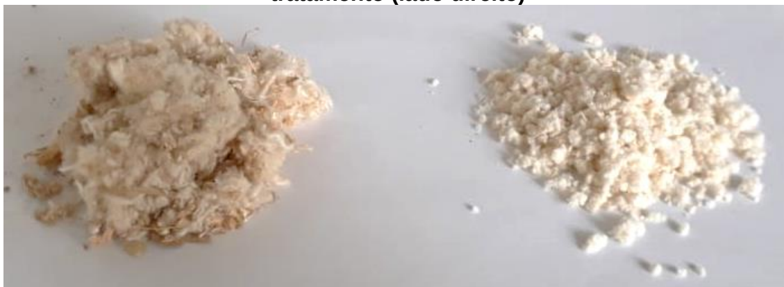
Figura 4 - Aspecto visual das bitucas sem tratamento (lado esquerdo) e após o tratamento (lado direito)
