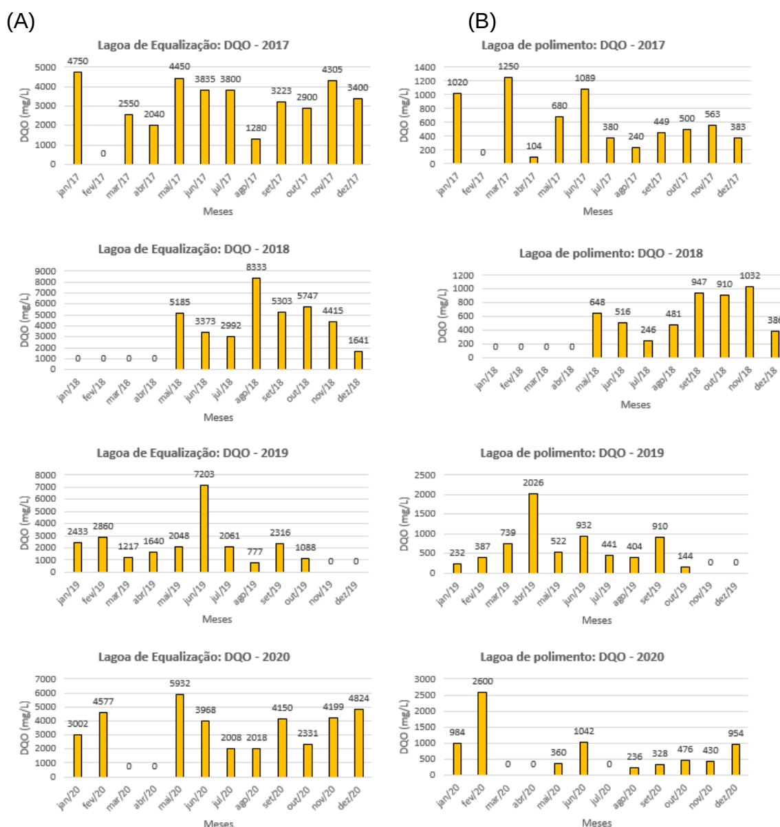
Figura 21- Resultados da análise de Demanda Química de Oxigênio (DQO), do relatório ambiental do tratamento de efluentes da Empresa Brasil Citrus, (A) antes do tratamento de efluentes, (B) depois do tratamento de efluentes.
