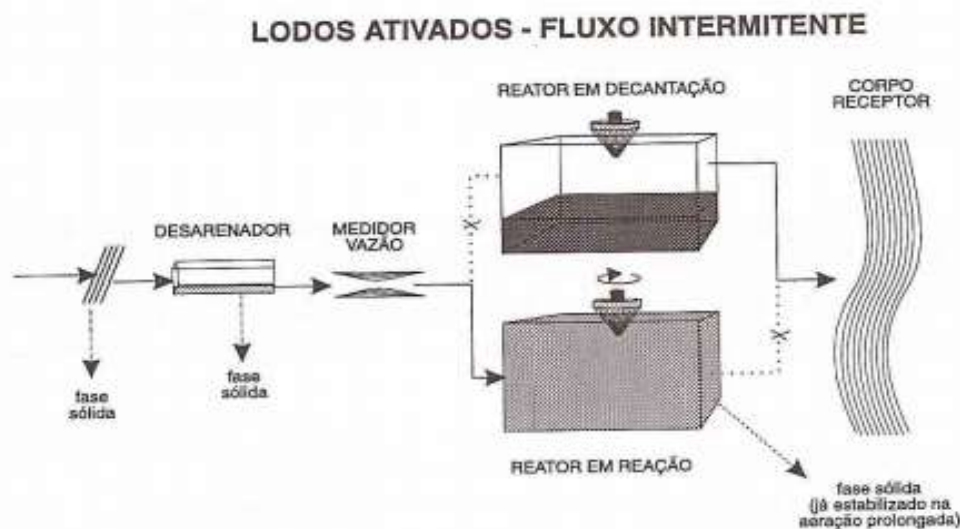
Figura 6. Esquema do tratamento de esgotos lodos ativados do tipo regime intermitente
