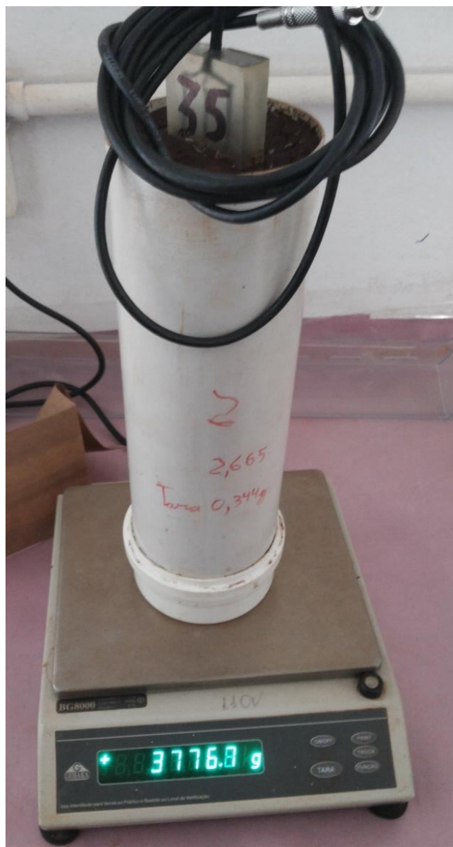
Figura 4. Calibração da TDR com o solo em colunas de PVC.
