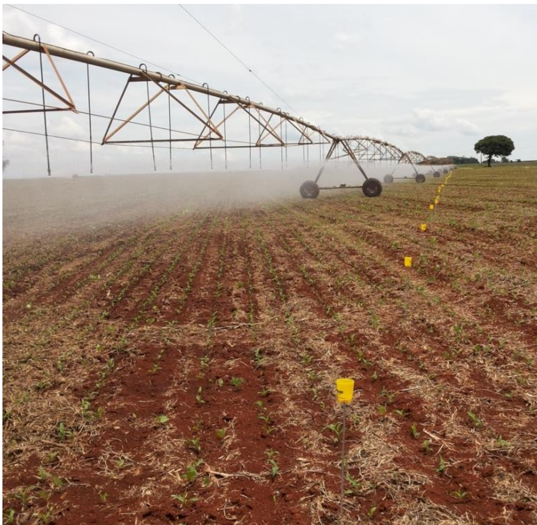
Figura 8. Teste de uniformidade do sistema de Irrigação pivô central.
