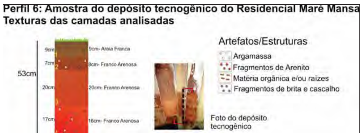
Figura 98: Perfil da amostra do depósito tecnogênico do Residencial Maré Mansa e texturas reconhecidas em cada camada de deposição.
