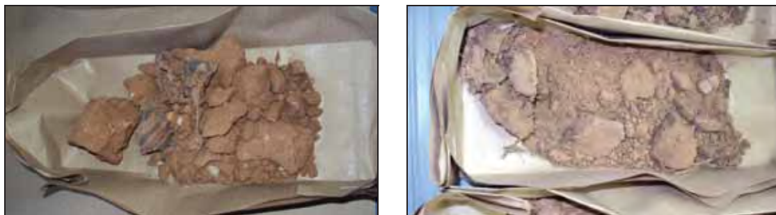
Figura 4: Parcelas de camadas dos depósitos tecnogênicos separadas para a secagem ao ar livre. Fonte: Da autora.
