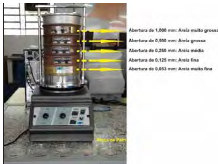
Figura 12: Fracionamento da areia. São destacadas as aberturas das peneiras e as equivalências quanto à classificação. Fonte: Da autora.
