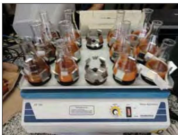
Figura 7: Agitação das amostras com hidróxido de sódio e água deionizada. Fonte: Da autora.
