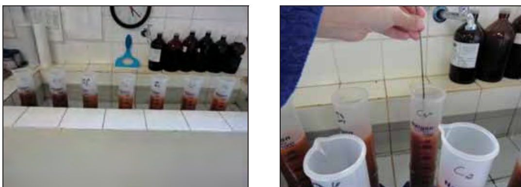
Figura 9: Provetas colocadas no tanque com água e agitação da solução. Fonte: Da autora.
