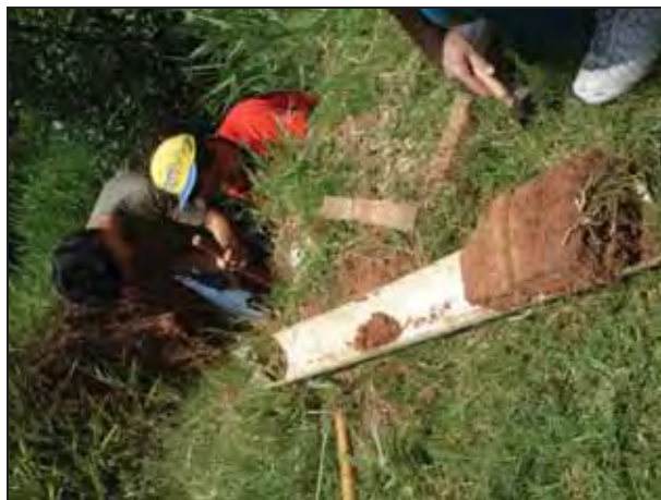
Figura 44: Coleta da amostra do depósito tecnogênico no Parque Alexandrina. Fonte: Da autora, trabalho de campo, 2010.
