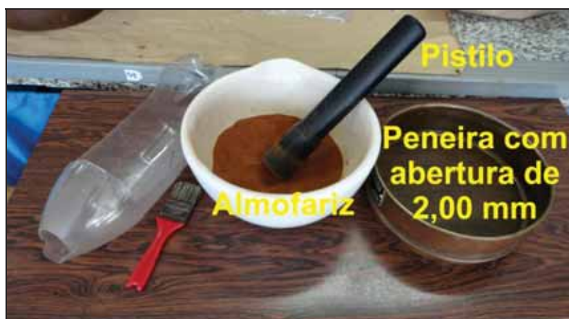
Figura 5: Etapa de destorroamento das amostras. Fonte: Da autora.
