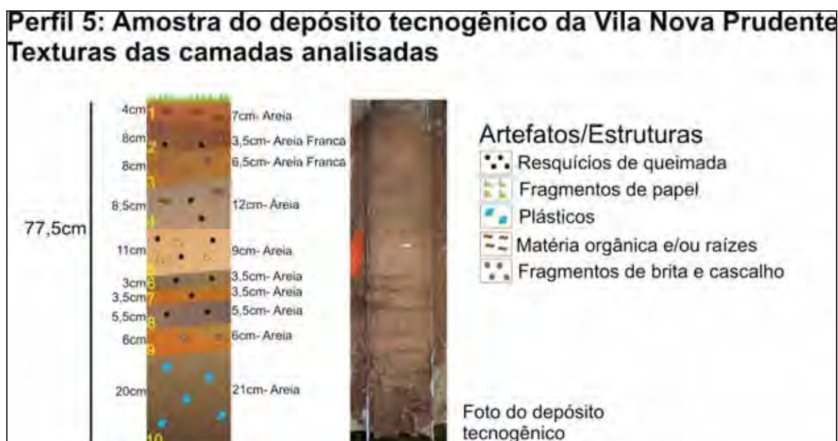
Figura 89: Perfil da amostra do depósito tecnogênico da Vila Nova Prudente e texturas reconhecidas em cada camada de deposição.
