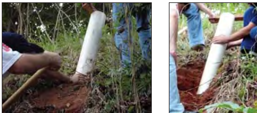
Figura 97: Processo de retirada da amostra do depósito tecnogênico no Residencial Maré Mansa realizado em duas etapas.
