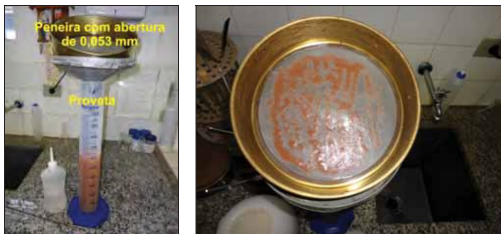
Figura 8: Filtragem da amostra utilizando a peneira de 0,053mm. Fonte: Da autora.
