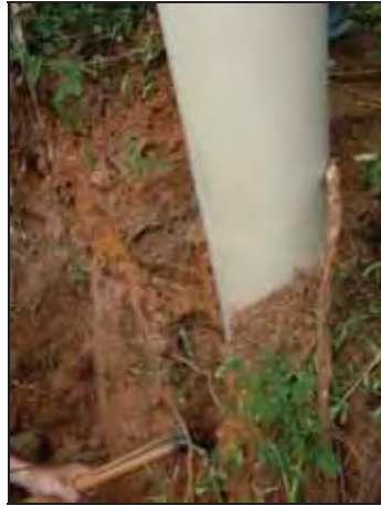
Figura 2: Procedimento de coleta dos materiais sedimentares com a penetração do tubo de PVC ao longo do perfil do depósito tecnogênico. Exemplo da coleta realizada no Jardim Itapura II.
