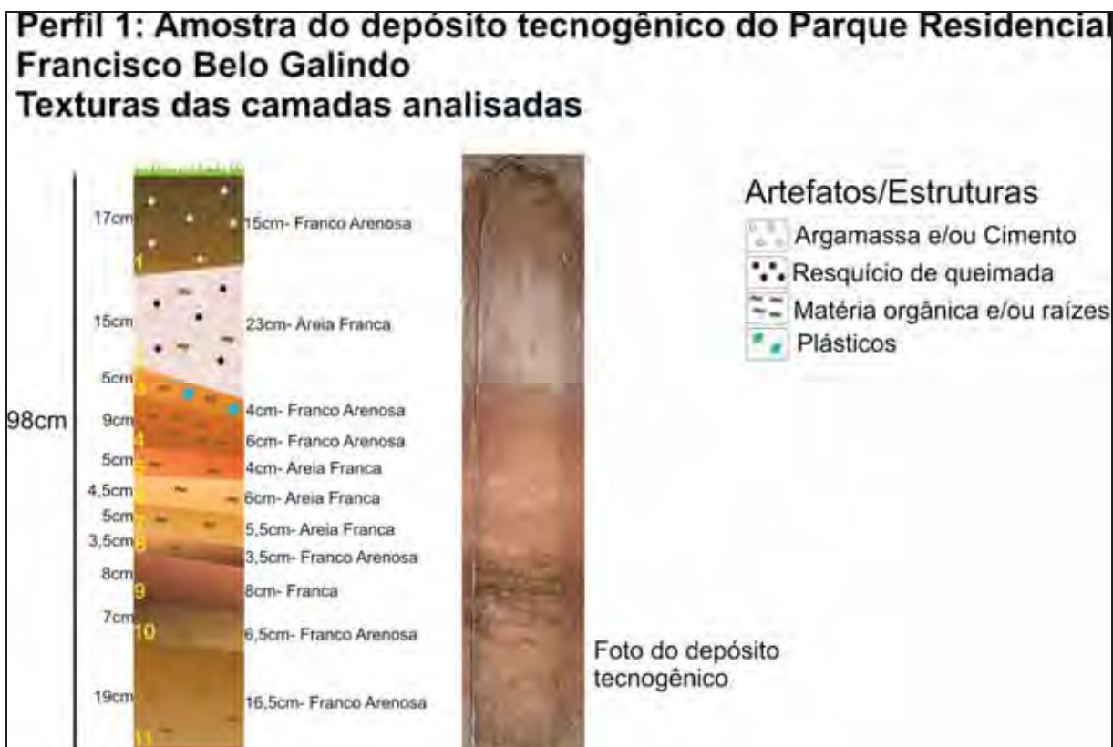
Figura 33: Perfil da amostra de depósito tecnogênico do Parque Residencial Francisco Belo Galindo e texturas reconhecidas em cada camada de deposição.
