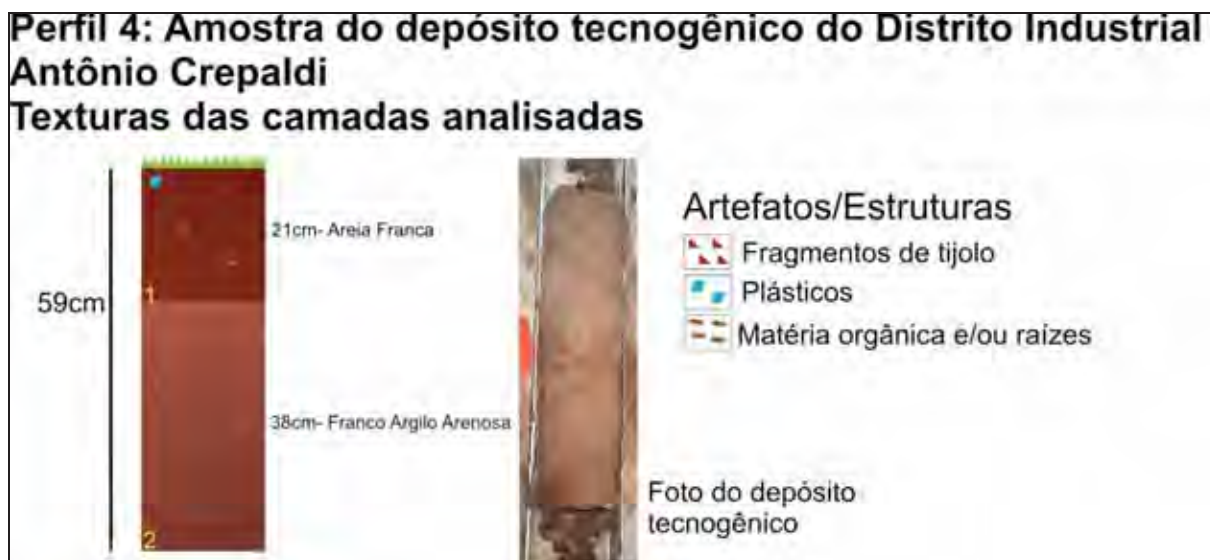
Figura 75: Perfil da amostra do depósito tecnogênico do Distrito Industrial I Antônio Crepaldi e texturas reconhecidas em cada camada de deposição.
