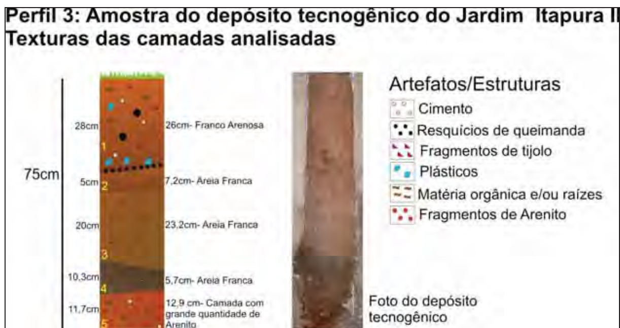
Figura 59: Perfil da amostra do depósito tecnogênico do Jardim Itapura II e texturas reconhecidas em cada camada de deposição.
