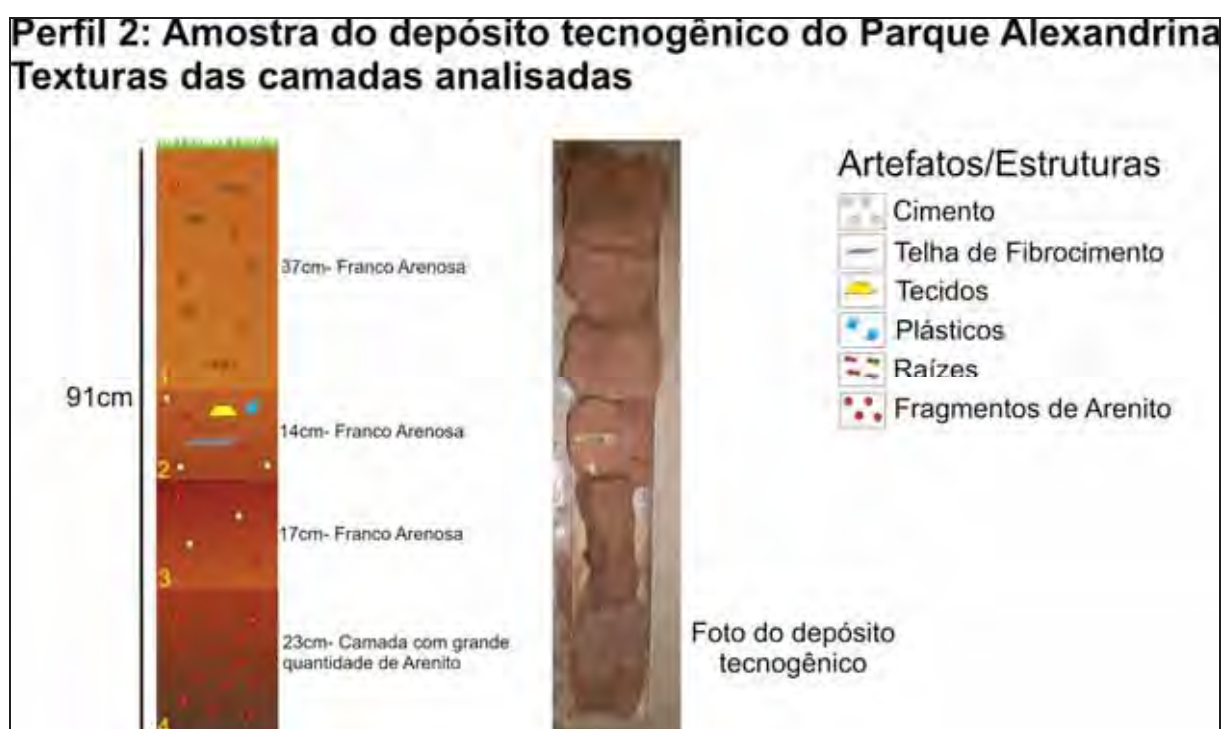
Figura 45: Perfil da amostra do depósito tecnogênico do Parque Alexandrina e texturas reconhecidas em cada camada de deposição.
