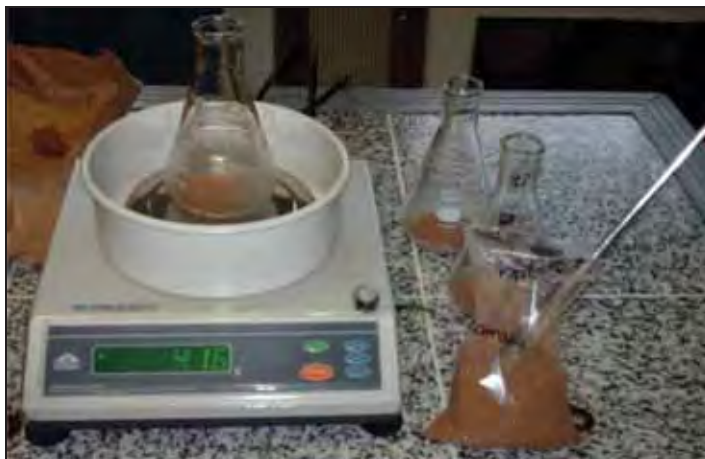
Figura 6: Pesagem de 10g de sedimentos de cada camada das amostras dos depósitos tecnogênicos. Fonte: Da autora.
