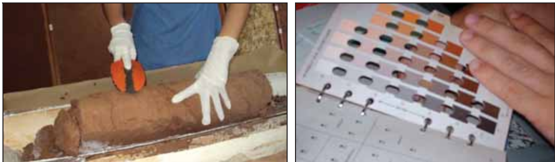
Figura 3: Procedimento de limpeza e reconhecimento das camadas e classificação da cor de cada uma destas.
