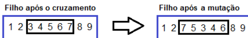
Figura 3.18 – Exemplo de mutação do tipo embaralhamento.
