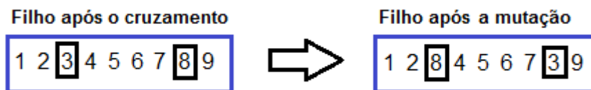
Figura 3.14 – Exemplo de mutação do tipo troca recíproca.
