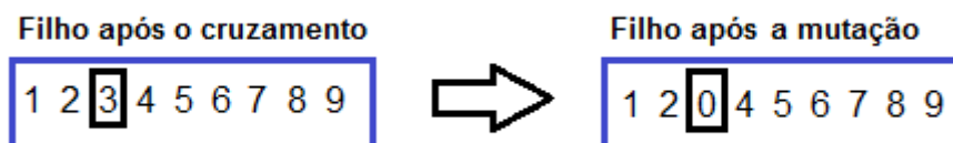
Figura 3.15 – Exemplo de mutação do tipo troca aleatória.
