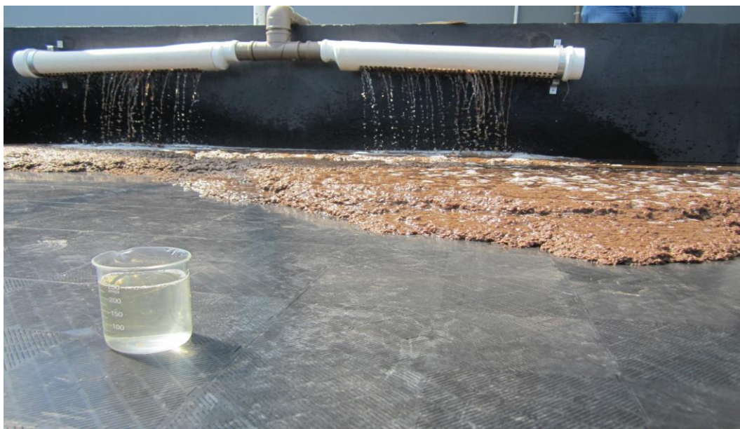
Figura 68 - Descarte de lodo aeróbio e amostra da água drenada nos blocos drenantes.
