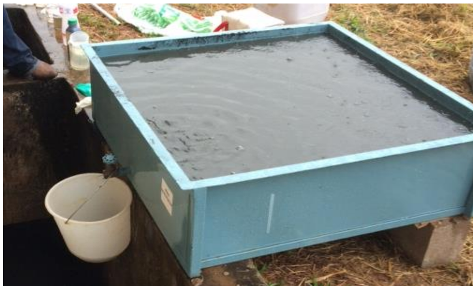
Figura 24 – Leito piloto com inclinação para escoamento através do registro.
