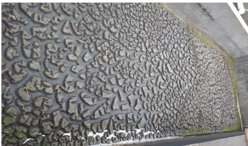
Figura 38 - Lodo do T4 T1 com 10 dias de secagem: fenômeno encolhimento.
