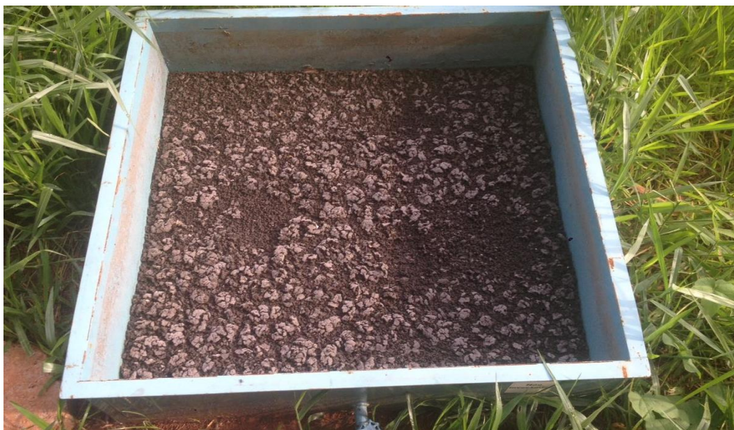
Figura 67 - Aspecto granular do lodo com 22 dias de secagem durante o TP 1.
