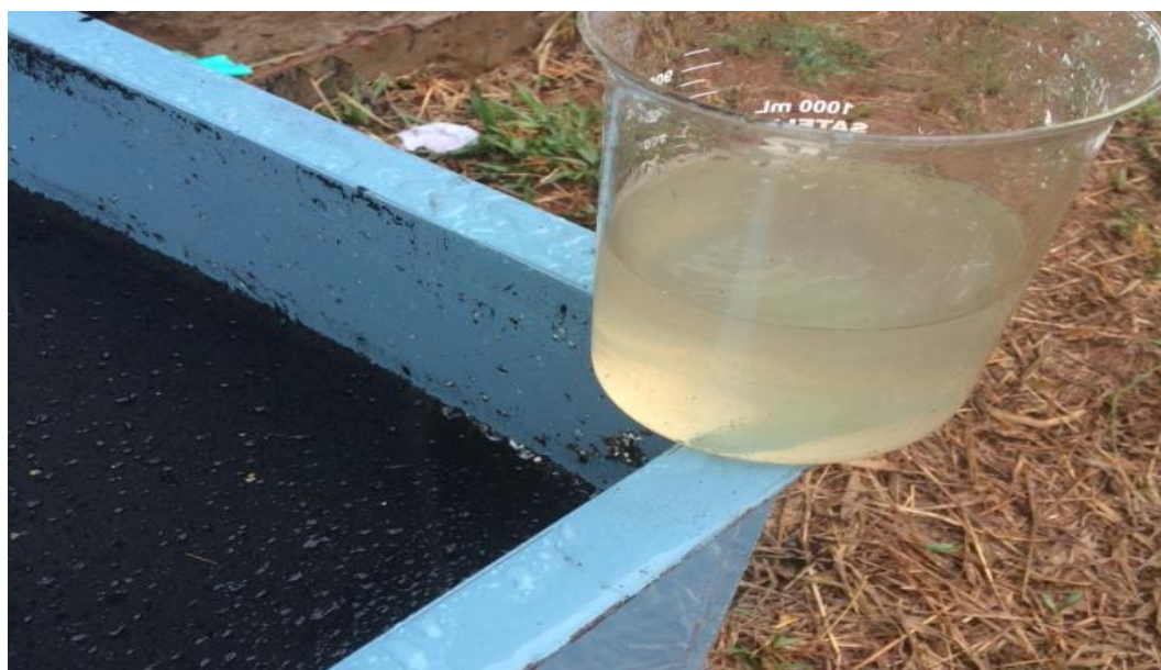
Figura 60 – Diferença entre o lodo retido e a água do lodo drenada.
