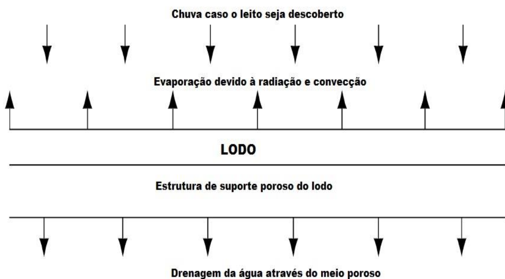
Figura 9 – Esquema do desaguamento do lodo em leitos de secagem. (Fonte: WANG et al , 2007)
