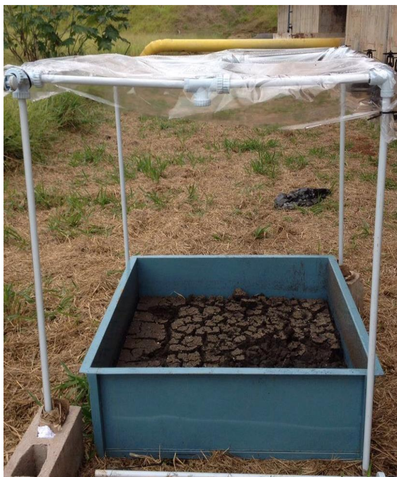
Figura 62 - Detalhe da cobertura transparente improvisada durante o TP 1.
