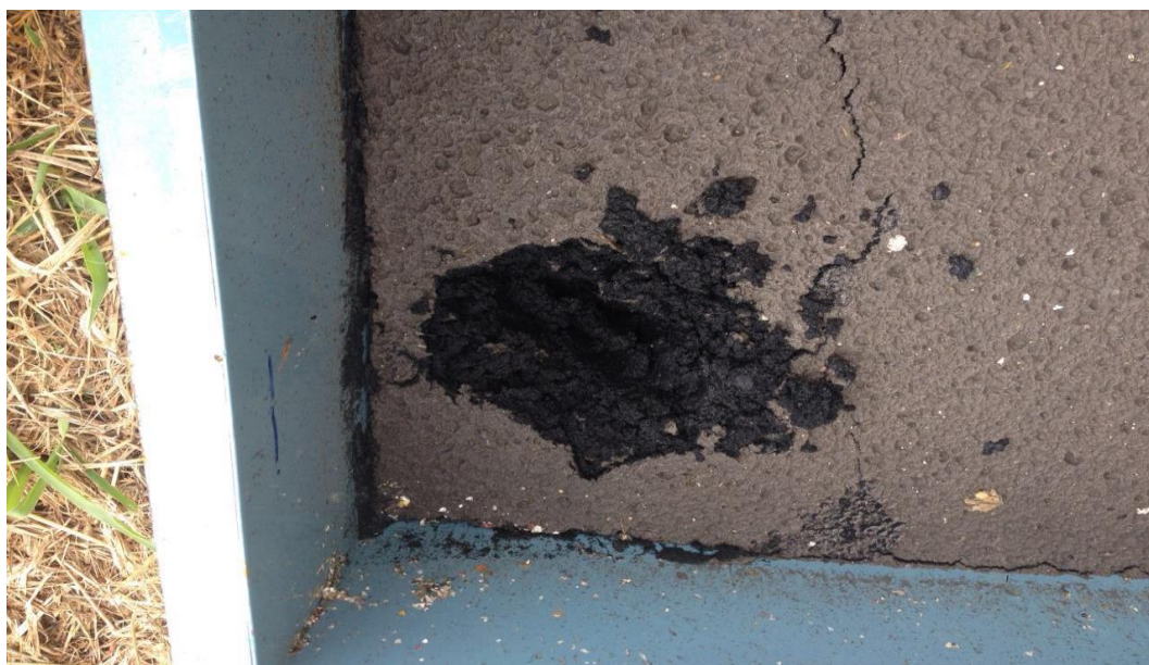
Figura 65 – Aspecto pastoso do lodo com 1 dia de secagem durante o TP 1.
