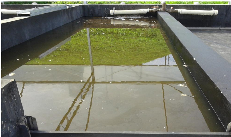
Figura 25 - Separação do lodo durante o descarte no Teste 1: por baixo camada sólida e água livre por cima.
