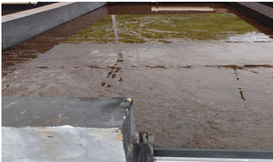
Figura 27 - Lodo desaguado mal flocculado no Teste 3, pouca liberação de água livre.
