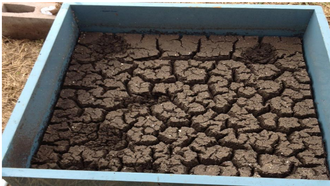
Figura 66 - Aspecto do lodo com rachaduras com 14 dias de secagem durante o TP 1.
