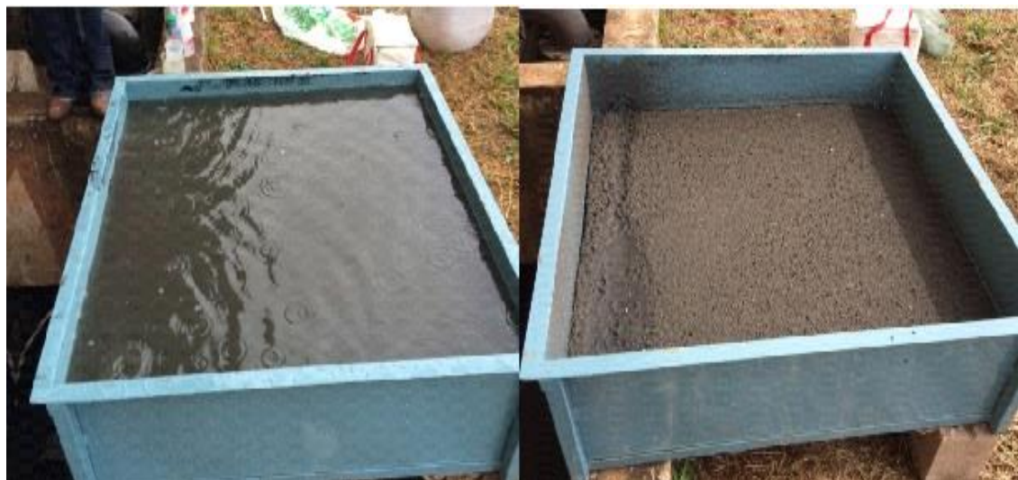
Figura 55 - Altura de camada de lodo após alimentação no leito piloto e após 24h do descarte do TP 1.
