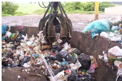
Figura 13: deposição do lixo orgânico (a) e garra de direcionamento para triagem (b)
