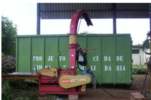
Figura 16: triturador (a) e cavacos provenientes de resíduos de poda e jardinagem (b)
