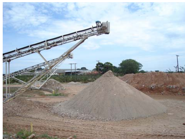
Figura 35: Usina de Reciclagem de Resíduos de Construção Civil da Progresso e Habitação de São Carlos S/A – PROHAB. Vista do triturador (a) e do agregado (b).
