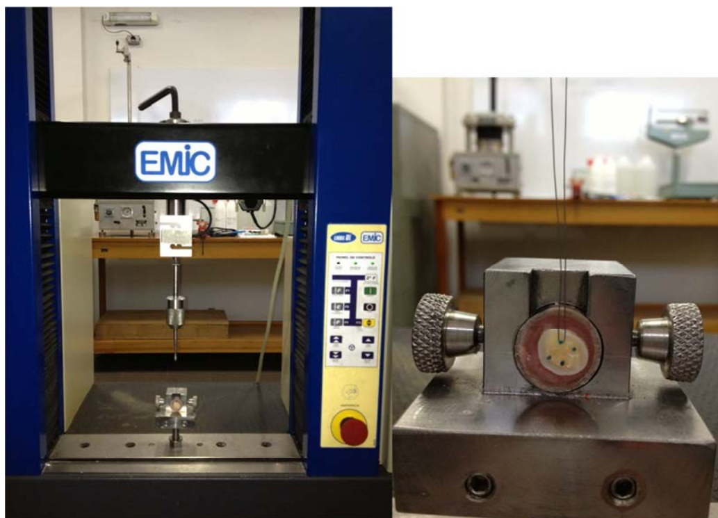
Figura A 7 – Ensaio mecânico de resistência de união ao microcisalhamento (EMIC DL 2000, São José dos Pinhais, PR, Brasil).
