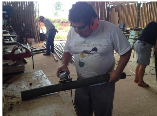
Fig. 02 Confeção de estruturas leves em bambu, produção do Grupo Viverde. Galpão-Oficina no Assentamento Rural Horto de Aimorés, 2014
