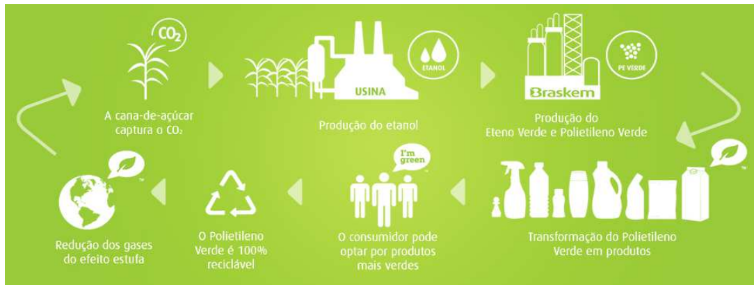
Figura 14 - Processo de Obtenção do Plástico Verde
