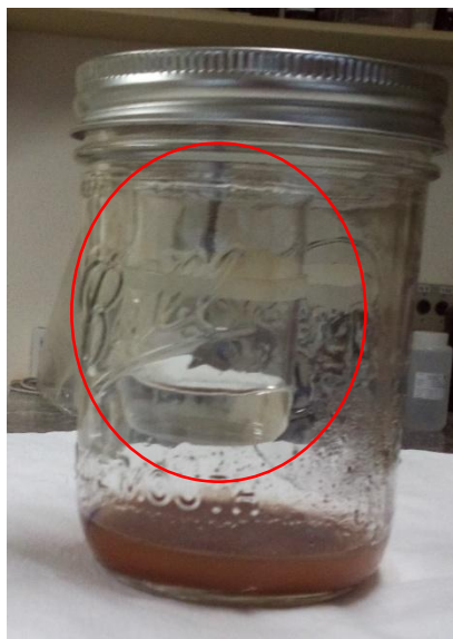
Figura 2. Recipiente hermeticamente fechado (Mason jar) com as adaptações para determinação do N pelo método Illinois Soil Nitrogen Test (N-ISNT).
