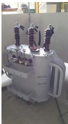
Figura 21 – Ensaio de elevação de temperatura no transformador de distribuição
