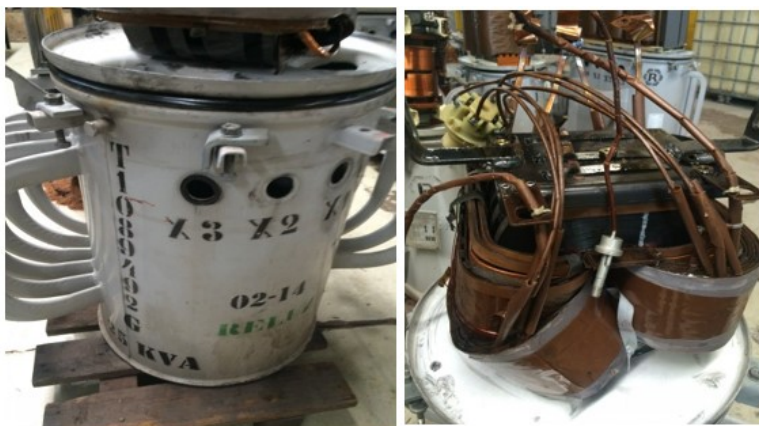
Figura 9 – Transformador que sofreu queima por curto-circuito externo
