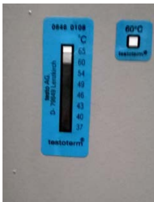
Figura 23 – Aspecto visual do adesivo em um transformador sobrecarregado
