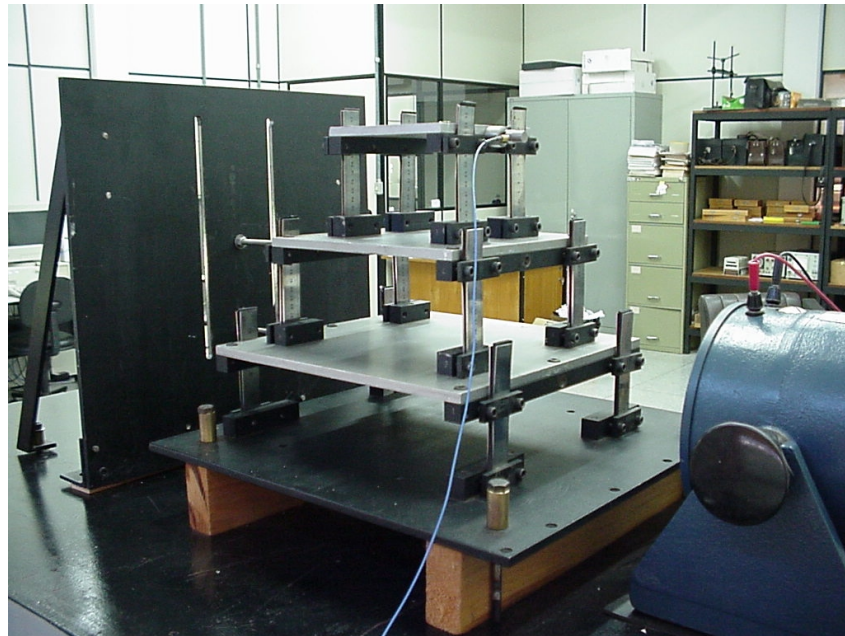
Figura (5.9): Obtenção de rigidez e amortecimento equivalentes da mesa m_3 , estando a mesa m_1 e a mesa m_2 fixadas em uma placa suporte de ferro fundido, presa à bancada.
