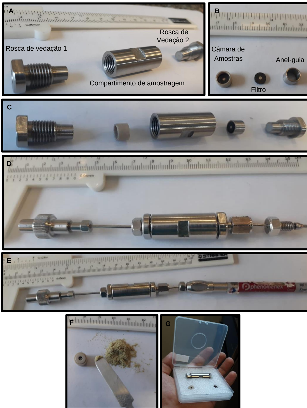
Figura 21. A) Partes externas: roscas de vedação e compartimento de amostras em aço inox. B) Partes internas: câmara de amostra (em PEEK) com filtro de linha embutido, filtro de linha e anel guia (aço inox). C) Alinhamento na ordem de encaixe. D) OLE montado com os adaptadores para o sistema cromatográfico. E) OLE plugado à coluna cromatográfica. F) Quantidade de material vegetal necessário e G) Caixa de armazenamento da peça.
