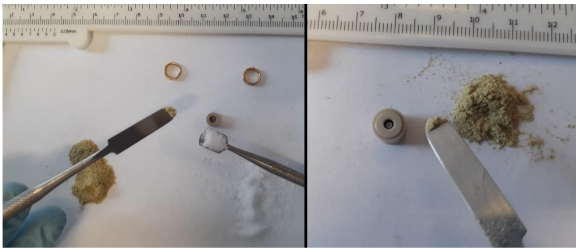
Figura 19. Alteração do preenchimento da câmara de amostras: à esquerda, preenchimento da câmara com sílica e material vegetal feita por Ferreira. À direita, apenas o material vegetal realizado com o atual modelo OLE.
