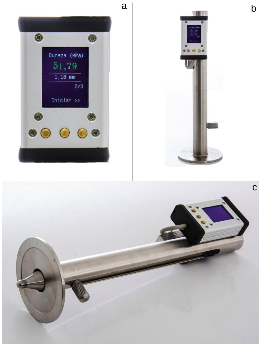
Figura 1 - Terceira versão do durômetro portátil: a) painel eletrônico de operação, b) equipamento na posição de operação, isto é, vertical e c) equipamento na posição horizontal
