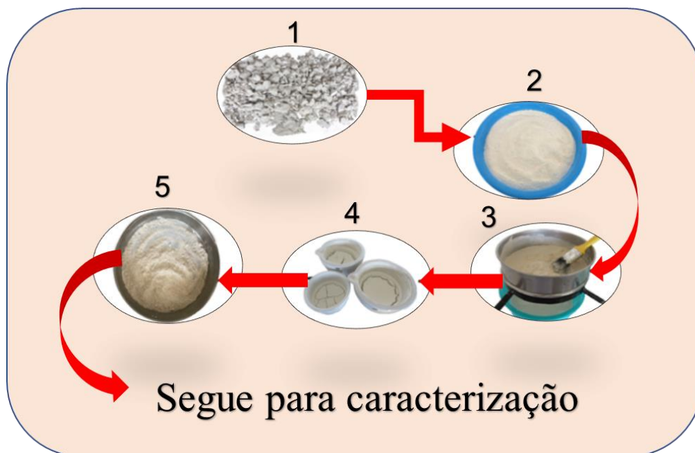
Figura 13 – Foto das etapas do processo de beneficiamento do caulim, secagem dos torrões (1), destorroamento (2), lavagem por via úmida (3), material seco em estufa (4) e peneiramento por via seca (5).
