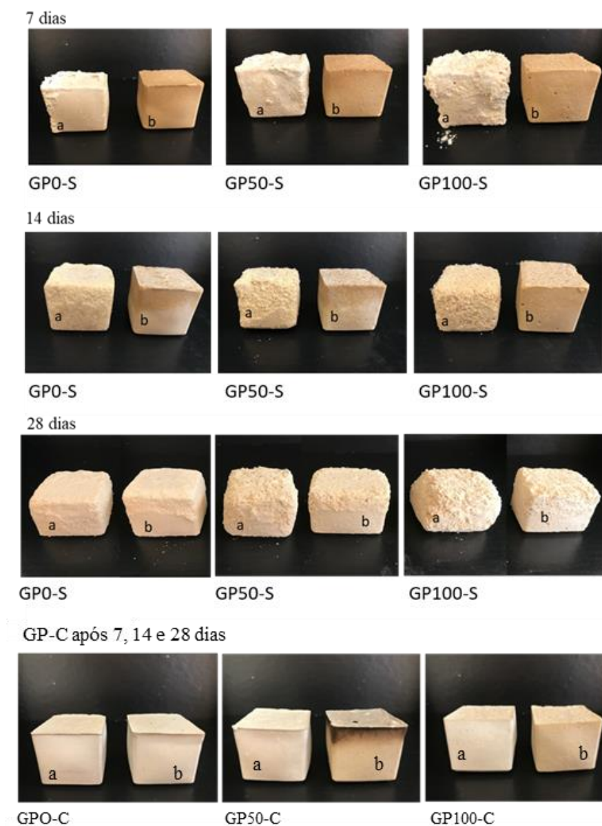
Figura 31 - Amostras após teste de florescência das argamassas GP-S e GP-C aos 7, 14 e 28 dias, secas ao ambiente (a) e submersas (b).
