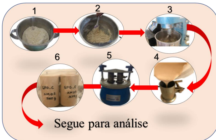
Figura 15 - Foto das etapas do processo de produção das argamassas, mistura dos materiais secos (1), mistura da solução ativadora e materiais secos (2), mistura mecânica (3), moldagem da argamassa (4), adensamento (5), e cura à temperatura ambiente (6).
