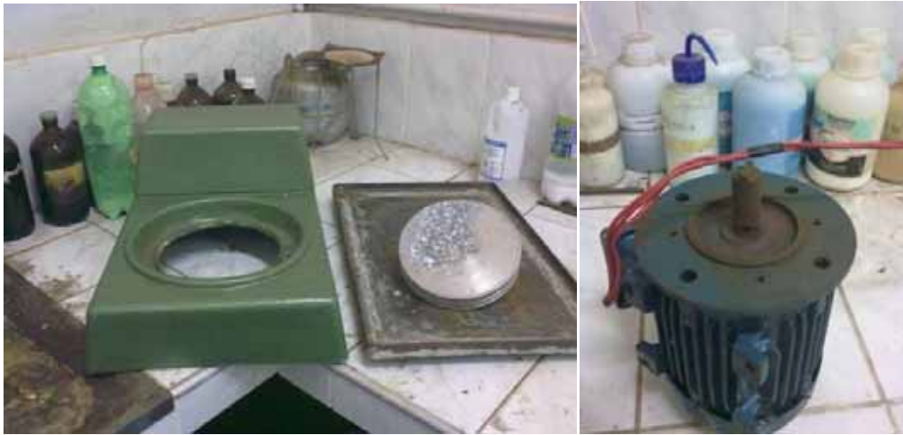
Figura 47- Equipamentos para a construção da máquina de polimento, capa de fibra de vidro, base de ferro, disco de alumínio e motor trifásico.
