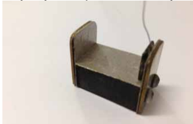
Figura 20– Aparato para realização da eletrodifusão no quartzo natural.
