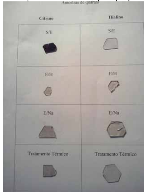
Figura 25 – Amostras de quartzo citrino e hialino, após exposição à radiação ionizante
