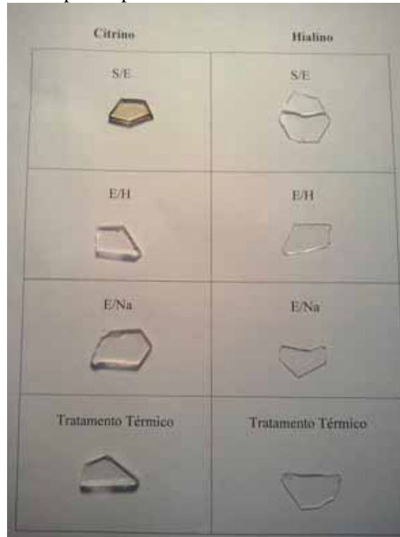
Figura 24 – Quartzo citrino e hialino após os processos de eletrodifusão e tratamento térmico à 500°C
