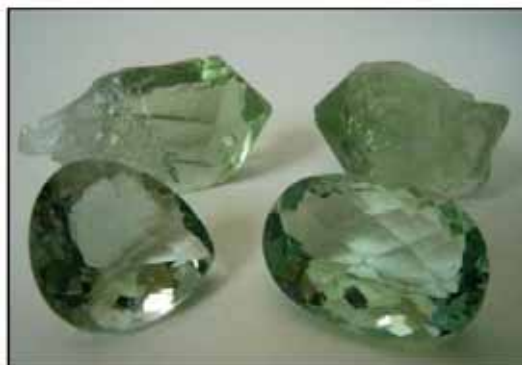
Figura 10- Cristais de quartzo verde produzido por irradiação e tratamento térmico de gemas de quartzo hialino.
