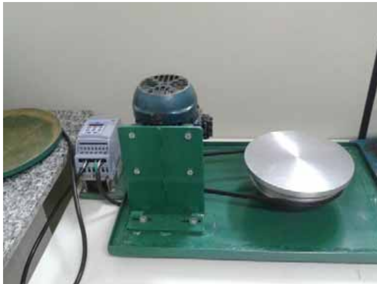
Figura 48 - Estrutura interna da máquina de polimento, montada sobre a placa de ferro e acoplada ao inversor de frequência.
