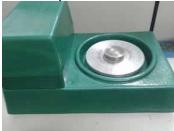
Figura 16– Máquina de polimento utilizada no processo de polimento e desbaste das amostras de quartzo.
