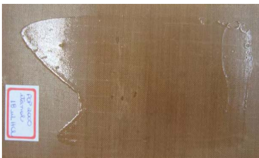
Figura 12. Filme preparado a partir do híbrido POP 2000 etanol na proporção 41,6, mostrando um filme regular e homogêneo.
