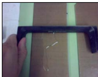
Figura 8. Precursor híbrido espalhado sobre uma placa acrílica recoberta com Teflon®, utilizando um extensor de filmes com cavidade de 10 mils.
