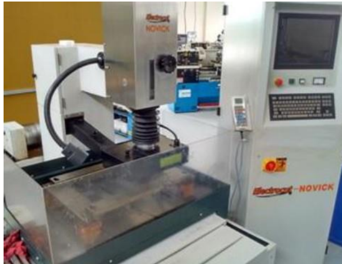
Figura 16 – Máquina de eletroerosão a fio Eletrocut NOVIK
