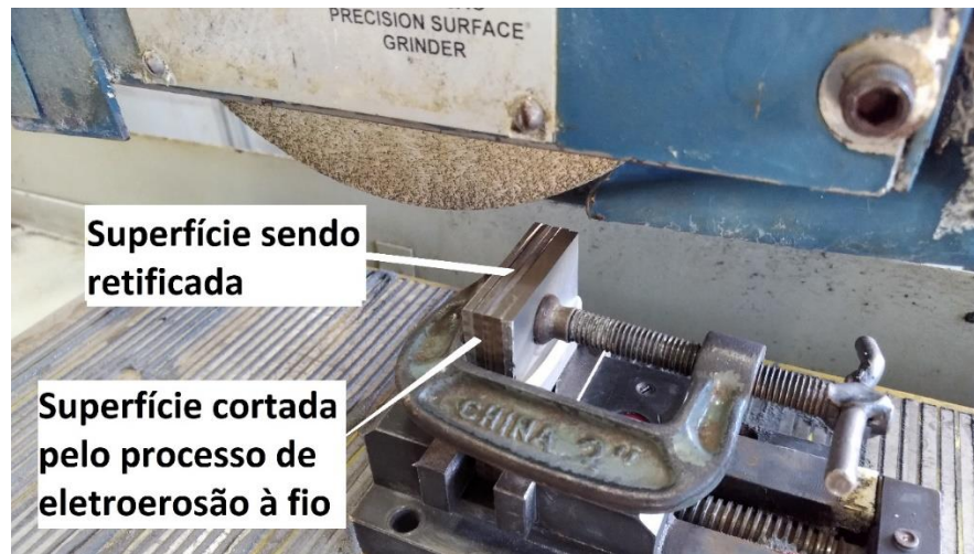
Figura 18 – Processo de retificação das chapas de AISD e AISA.
