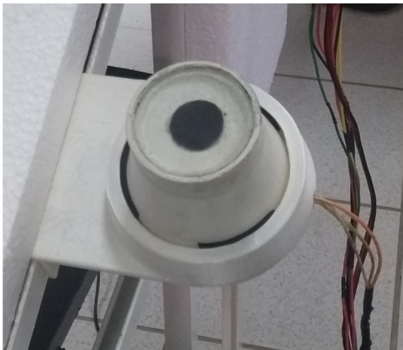
Figura 4.19: Radiômetro instalado no secador.
