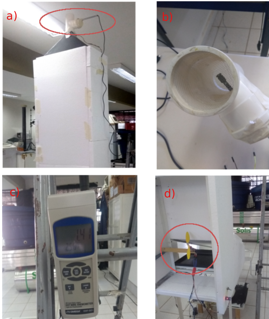
Figura 4.9: Representação da calibração do anemômetro tipo turbina.
