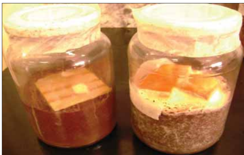
Figura 8. Início do ensaio (inoculação do fungo sobre o alimentador) e após 12 semanas de incubação com o fungo Pycnoporus sanguineus já com os corpos de prova da madeira de E. grandis .
