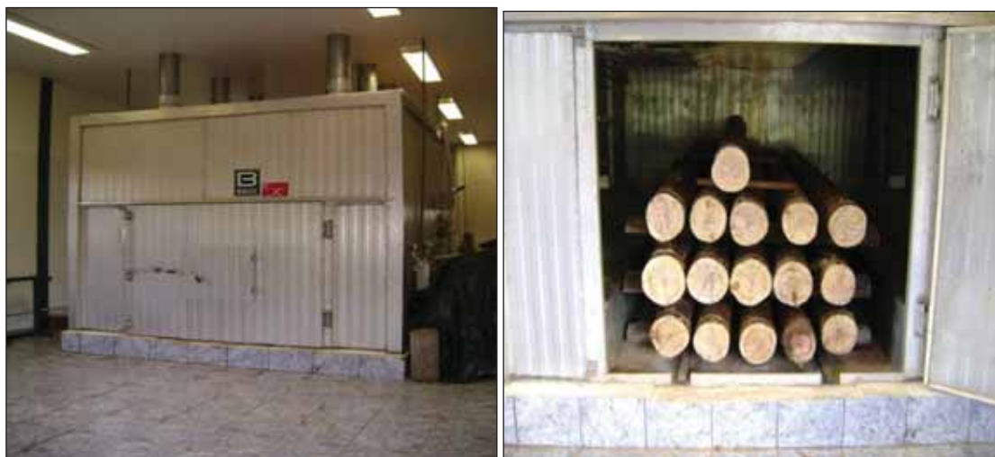
Figura 3. Aplicação do tratamento de vaporização em toras.
