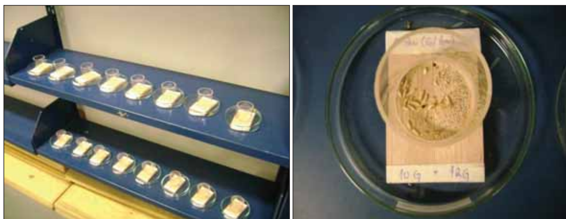
Figura 9. Condicionamento durante o ensaio e detalhe de um dos pares de corpos de prova da madeira de E. grandis após 45 dias de exposição a Cryptotermes brevis .
