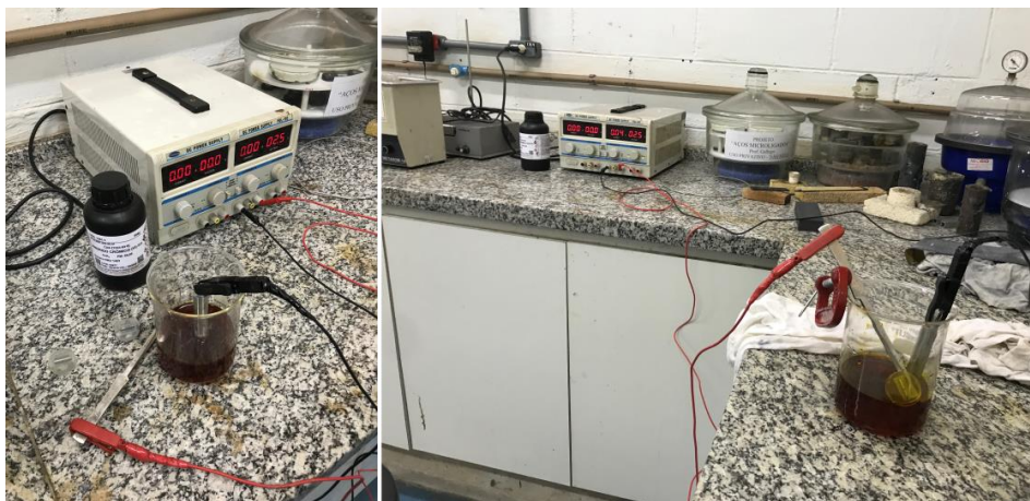
Figura 2.2– Ataque Eletrolítico das amostras: Eletrólise em solução de ácido crômico ( \text{H}_2\text{CrO}_4 ).
