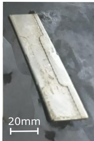
Figura 2.6 – Obtenção das amostras das chapas soldadas para ensaio de tração.
