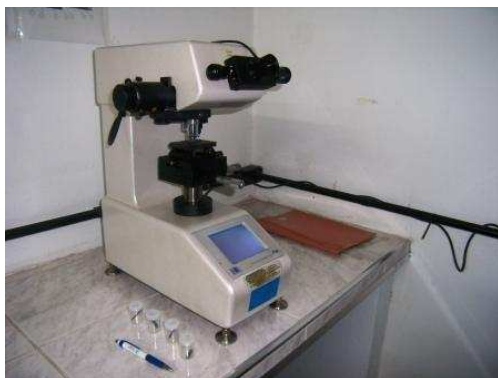
Figura 37 – Equipamento utilizado no ensaio de dureza Vickers e detalhe do penetrador.
