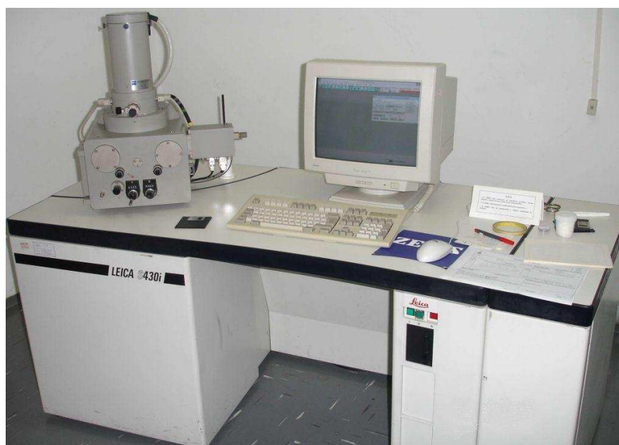
Figura 39 – Microscópio Eletrônico de Varredura modelo LEICA S430i, - AMR-CTA.
