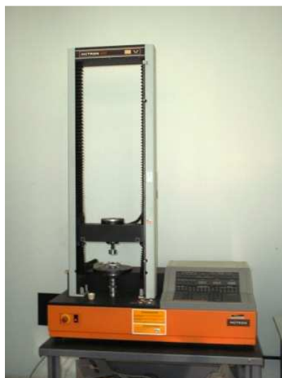
Figura 35 – Máquina de ensaios universal de ensaios Instron, modelo 4301 utilizada nos ensaios de flexão por 4 pontos AMR – CTA.
