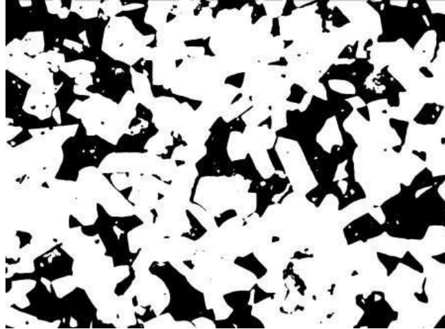
Figura 51 – Imagem de microscopia óptica de uma cerâmica de Sic transformada em dois níveis, nesse caso, as áreas em preto representam os poros.
