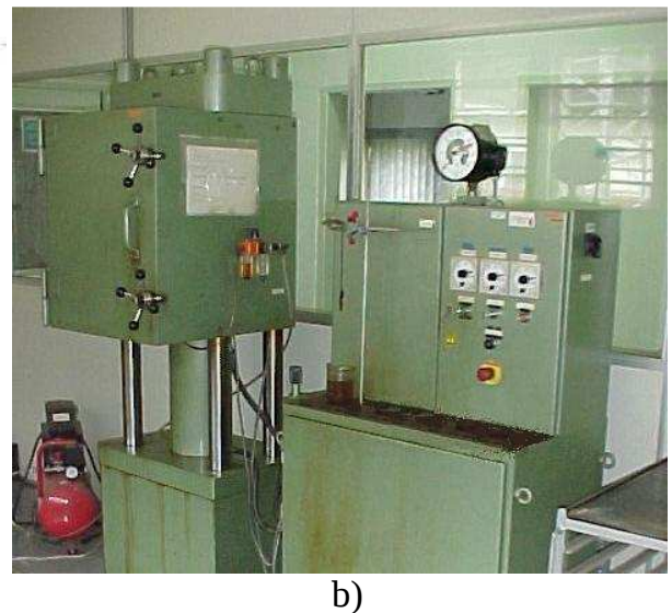
Figura 31 – (a) Esquema de funcionamento e (b) Prensa utilizada para prensagem isostática AMR – CTA
