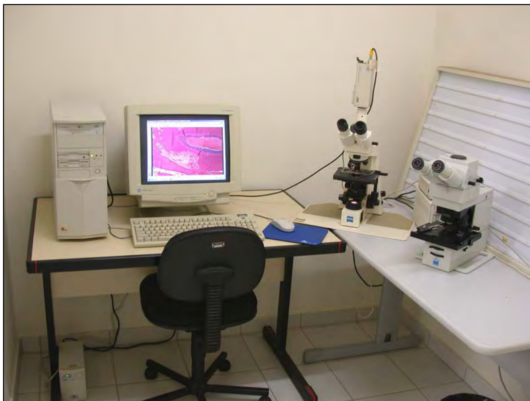
FIGURA 34 - Equipamento utilizado na captação das imagens histológicas. Câmera digital (JVC TK-1270 Color Vídeo Câmera) acoplada ao microscópio Carl Zeiss (AxioLab) e conectada ao computador.
