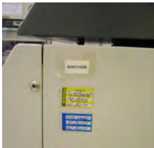
Ilustração 13 – Etiquetas de calibração e manutenção preventiva em centrífuga imunohematológica
