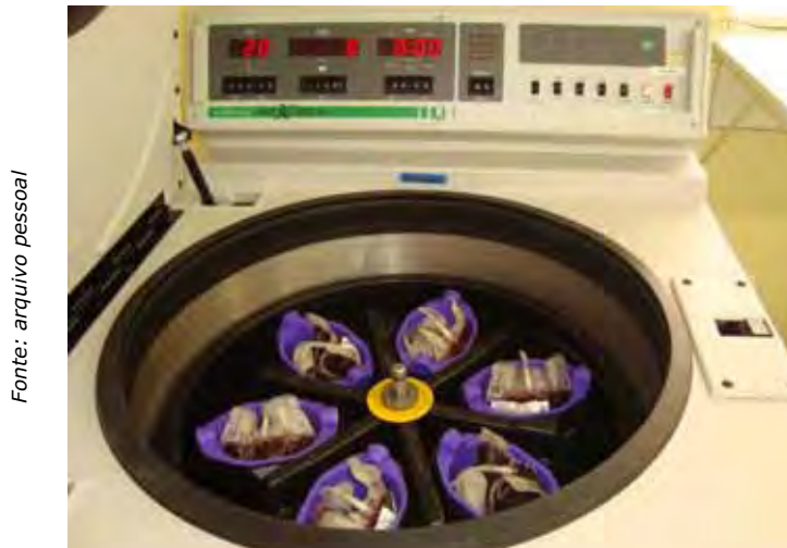
Ilustração 14 – Centrífuga refrigerada para separação do sangue total
