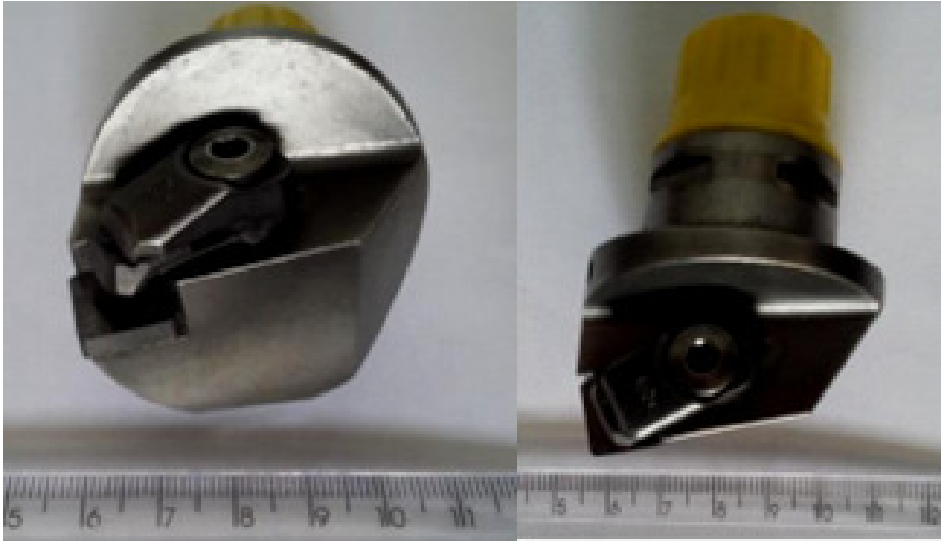
Figura 33 - Porta-ferramenta SECO TOOLS Capto B01T9032445.
