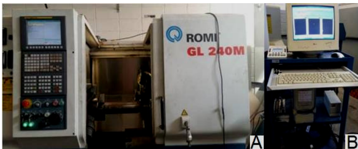
Figura 29 - A) Centro de torneamento CNC marca Romi modelo GL240M B) sistema de aquisição de dados acoplado
