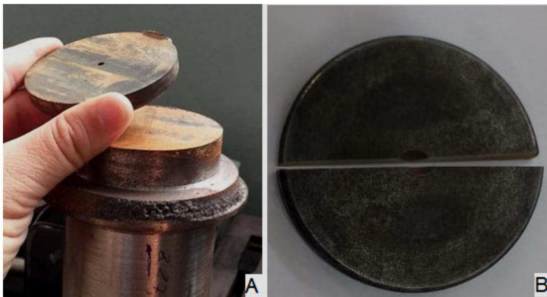
Figura 35 - Corte da amostra A) primeiro corte B) diâmetro dividido ao meio.
