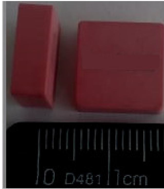
Figura 32 - Ferramenta cerâmica \text{Al}_2\text{O}_3 + \text{Cr}_2\text{O}_3
