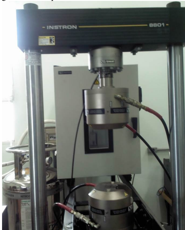
Figura 25 - Máquina Universal de Ensaio Instron 8801
