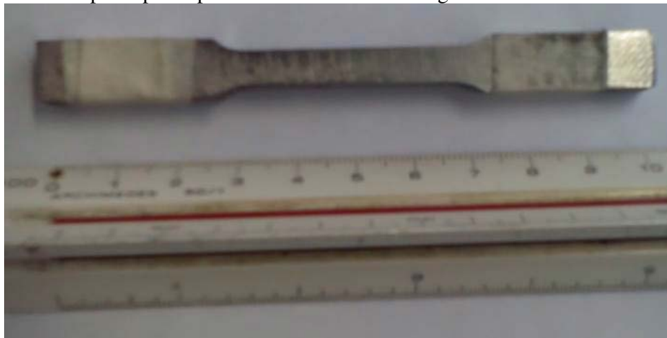
Figura 24 - Corpo de prova para análise de vida em fadiga conforme norma ASTM E466
