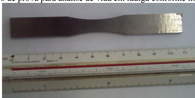
Figura 23 - Corpo de prova para análise de vida em fadiga conforme norma ASTM E466
