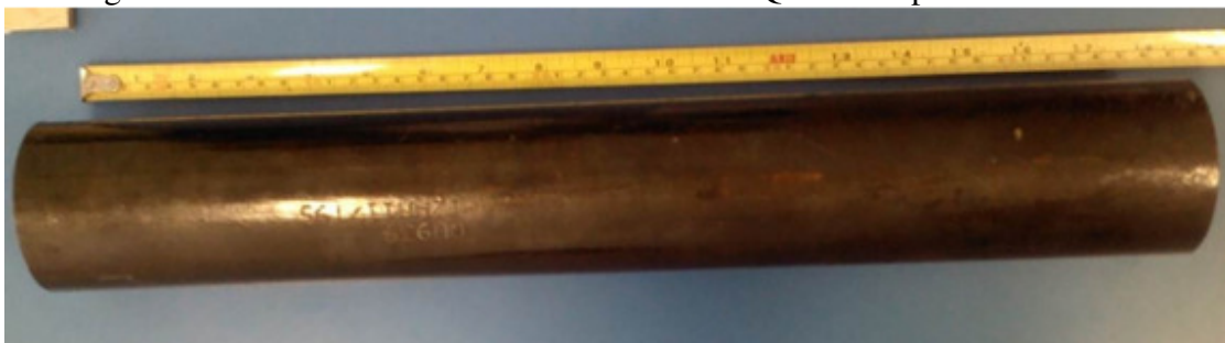
Figura 21 - Tubo API 5CT T95 - Rastreabilidade QU939 - Apolo Tubulars S/A
