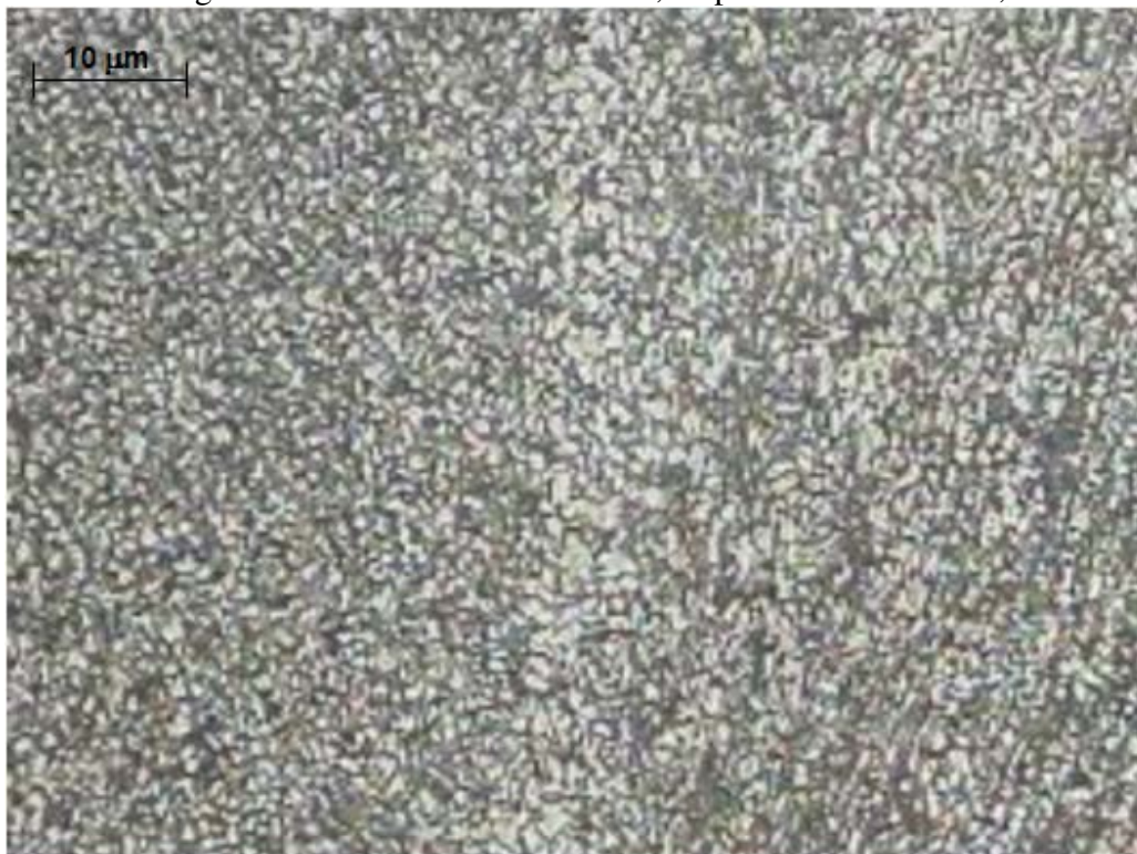
Figura 35 - Micrografia do centro da linha de solda, amplitude de 150 vezes, API 5CT T95
