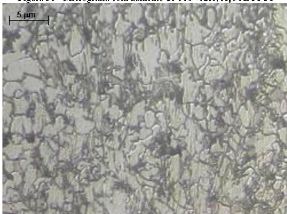
Figura 36 - Micrografia com aumento de 600 vezes, Aço API 5CT
