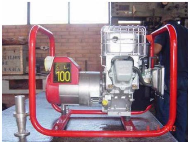
Figura 9 – Motogerador adaptado por Souza (2006)
