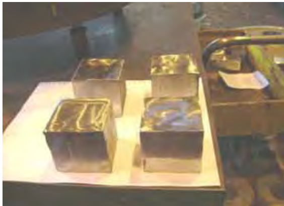
Figura 19. Corpos de prova preparados e sendo realizado ensaio de ultrassom.
