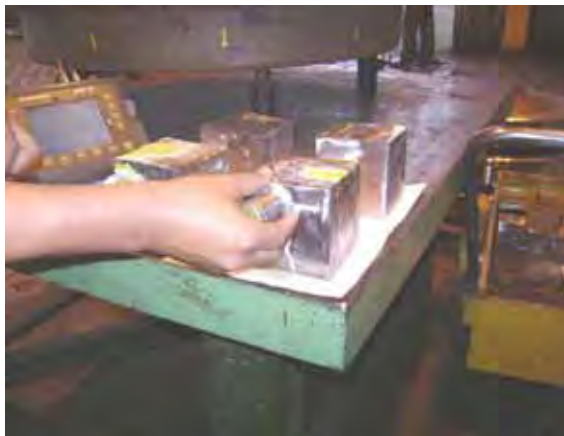
Figura 20. Corpos de prova sendo realizado ensaio de ultrassom e corpo de prova já com as linhas para corte de serra traçadas.
