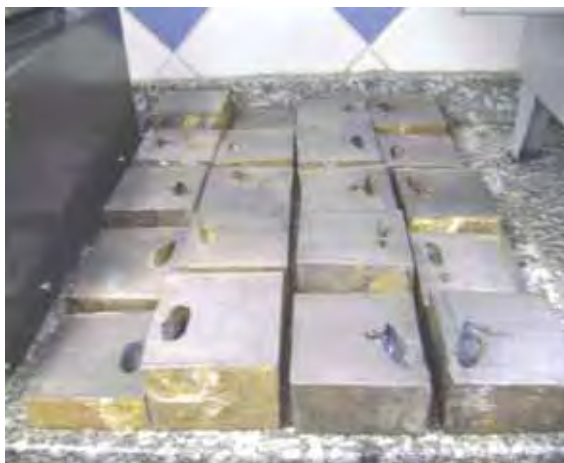
Figura 21. Corpos de prova já serrados.
