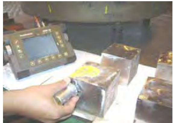
Figura 19. Corpos de prova preparados e sendo realizado ensaio de ultrassom.
