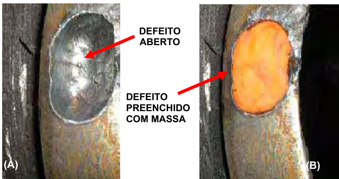
Figura 17. Método de medição do defeito (GARCEZ; ALVES, 2006).
