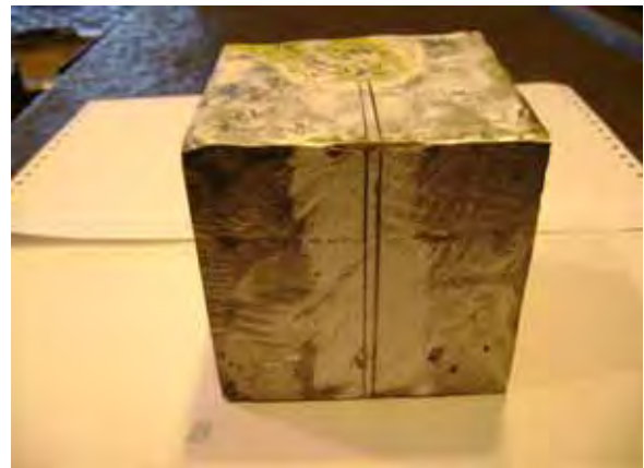
Figura 20. Corpos de prova sendo realizado ensaio de ultrassom e corpo de prova já com as linhas para corte de serra traçadas.
