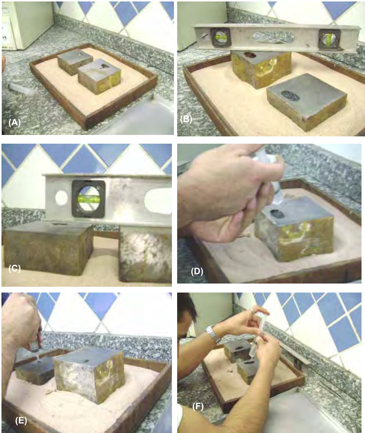
Figura 22. Ilustração do sistema e da sequência de medição. (A), (B) e (C) nivelamento do corpo de prova; (D), (E) e (F) injeção de água destilada para medir volume do defeito.
