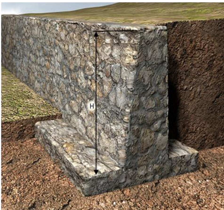
Figura 2 – Muro de Concreto Ciclóptico.
