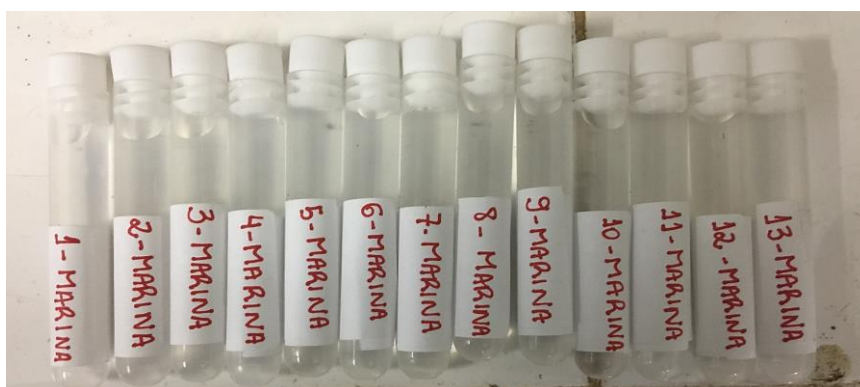
Figura 45 - Amostras de água acondicionadas para análise no Picofox, mostrando que um volume pequeno já é suficiente para detectar até os elementos mais vestigiais.
