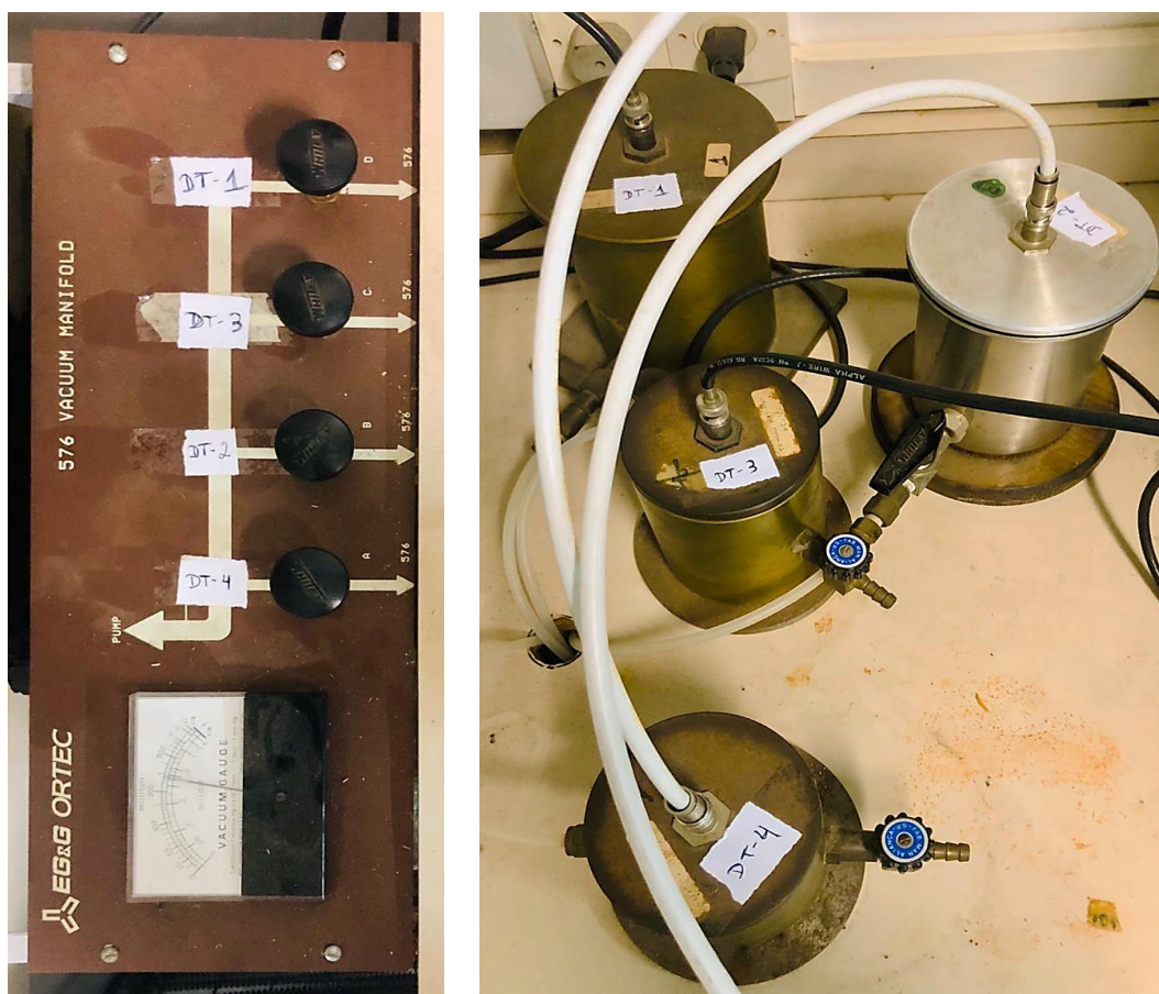
Figura 43 - Sistema de detecção da ORTEC com quatro detectores simultâneos (DT-1, DT-2, DT-3 e DT-4).
