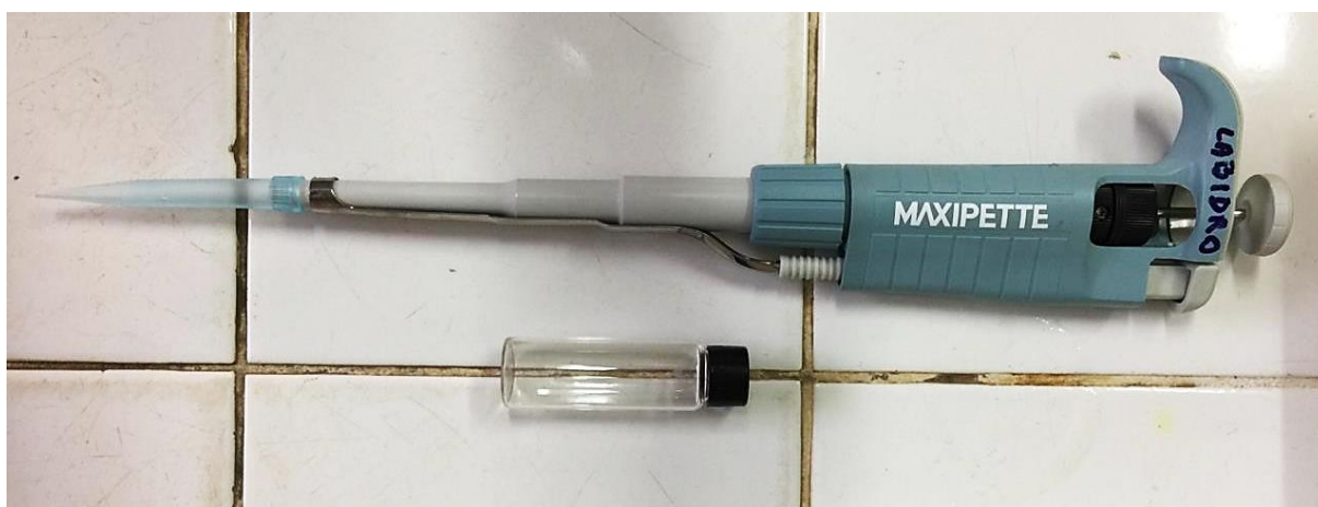
Figura 34 - Pipeta e frasco contendo o traçador artificial ^{232}\text{U} .
