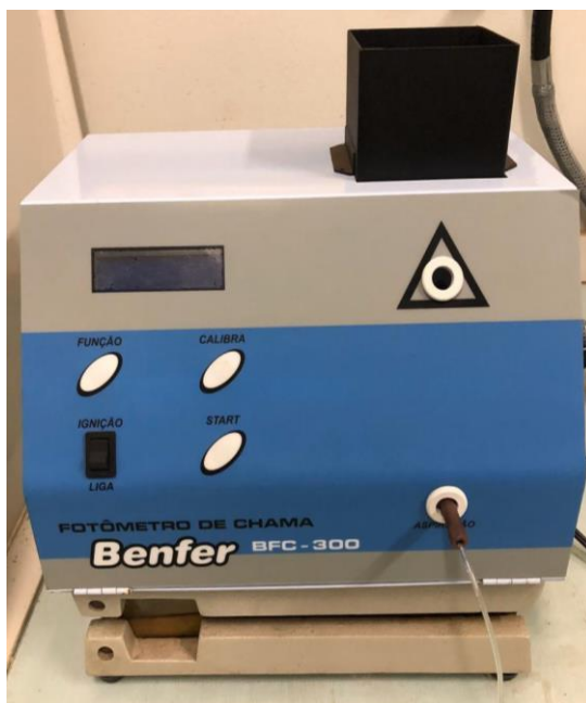
Figura 21 - Fotômetro de chama digital do Labidro, modelo BFC-300 da Benfer, para análises de Na, K e Li.
