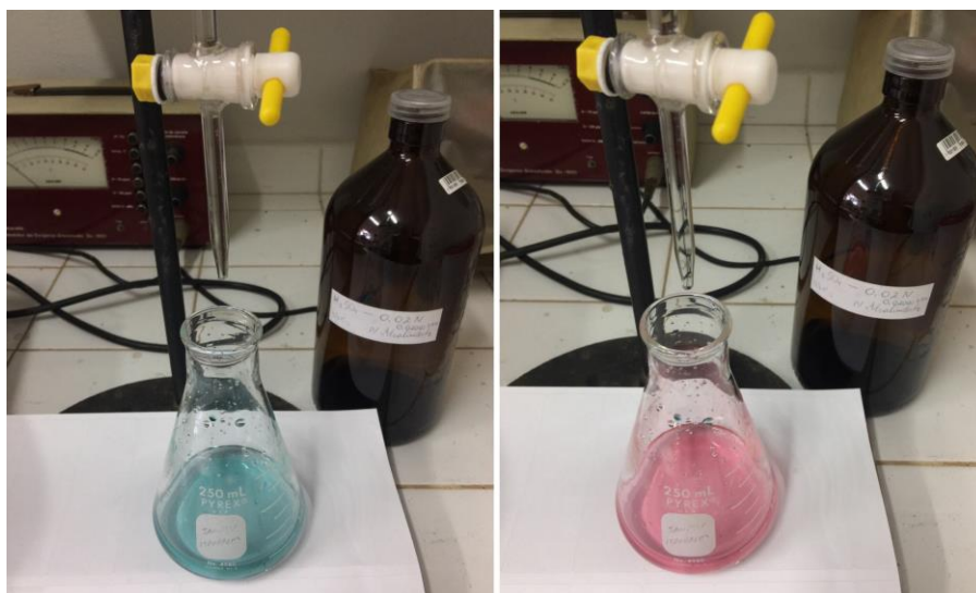
Figura 22 - Titulação com ácido para determinação de alcalinidade.
