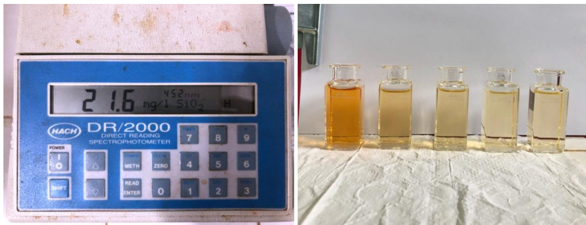
Figura 23 - À esquerda, espectrofotômetro Hach durante uma medição de SiO 2 . À direita, ampolas contendo amostra e reagente logo após o fim dos testes colorimétricos. A diferença nas tonalidades está diretamente relacionada com o teor de sílica.
