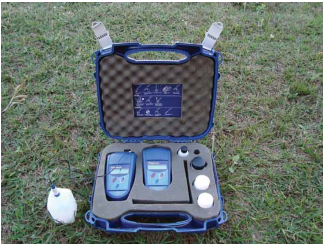
Figura 4. Equipamentos de medição dos parâmetros físico-químicos em campo.
