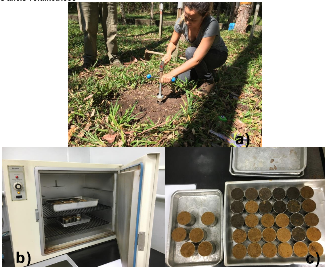
Figura 4 – Etapas do processo de coleta e secagem das amostras: a) Coleta dos anéis volumétricos com auxílio de trado b) Amostras em estufa no laboratório c) Amostras de solo nos anéis volumétricos
