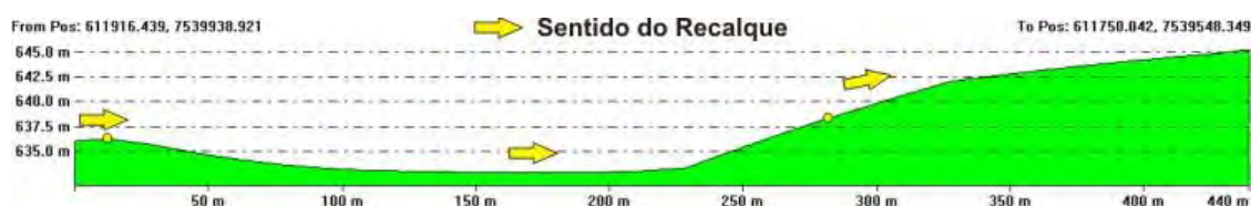
Figura 46: Perfil topográfico do emissário por recalque 1.1.
