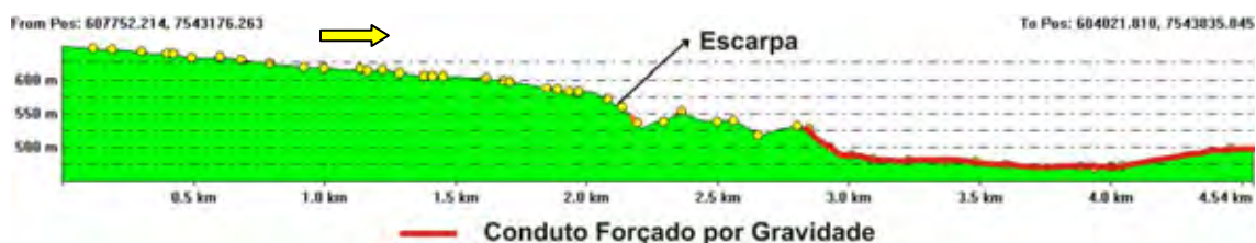
Figura 72: Perfil topográfico do emissário 3.5.
