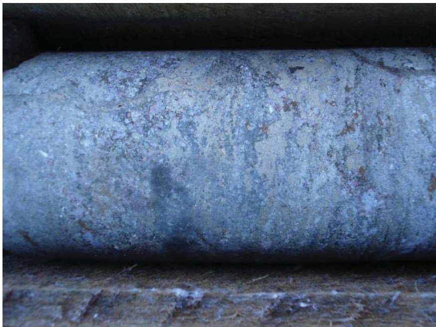
Figura 7.4.5_6 – Detalhe da pirita disseminada na matriz do metadiamicrito
