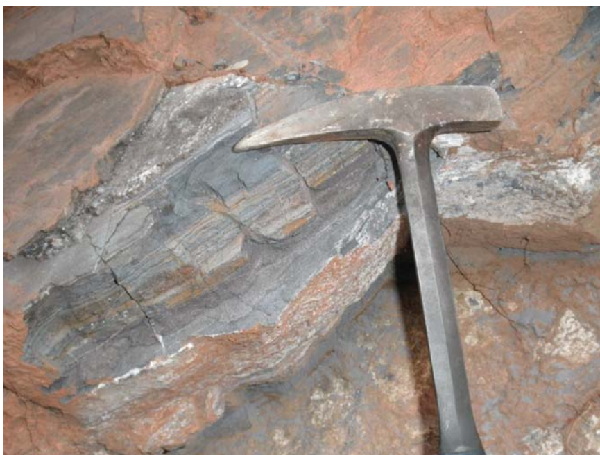
Figura 7.6_5 – Formação Ferrífera bandada composta por hematita, magnetita e quartzo, com cristais de magnetita preservados em meio ao bandamento
