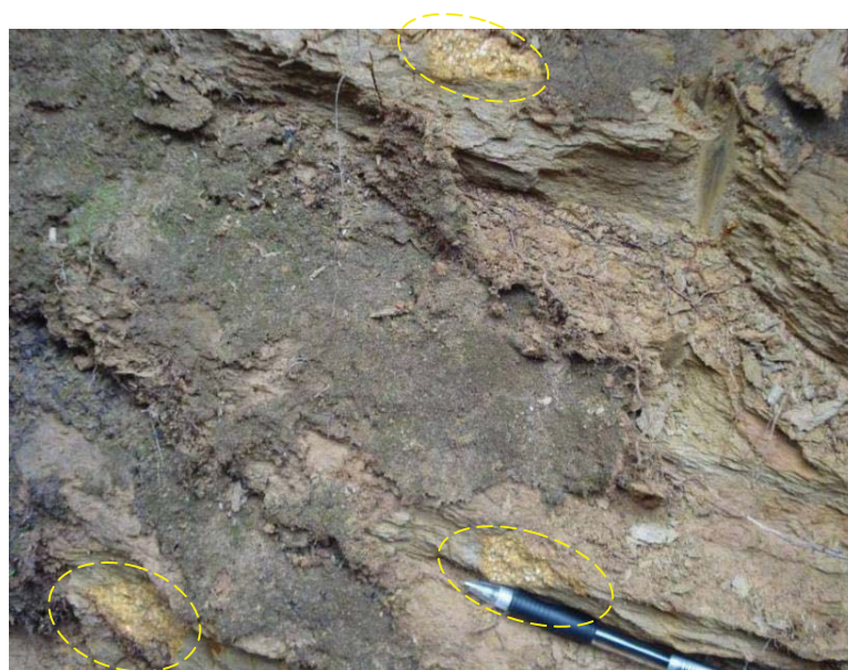
Figura 7.3.1_4 – Afloramento do metadiamiclito com matriz quartzo-micácea com clastos de granitoides em sua matriz, marcados com círculos tracejados em amarelo
