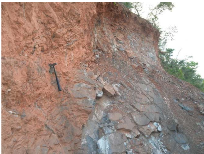
Figura 7.6_4 – Trincheira visitada na região de ocorrência das formações ferríferas, mostrando um solo de alteração vermelho magnético, seguido por um nível de saprólito e por uma formação ferrífera bandada na base
