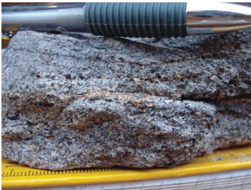
Figura 7.4.2_2 – Bloco de quartzito ferruginoso, com textura média a grossa, composta basicamente de quartzo e magnetita
