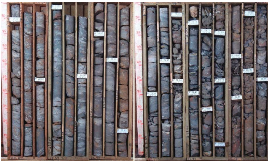
Figura 8.2.1_3 – Intervalos brechados, fraturados e com especularita friável descritos no furo FD007, primeiro furo a leste na seção da figura 9.2_2
