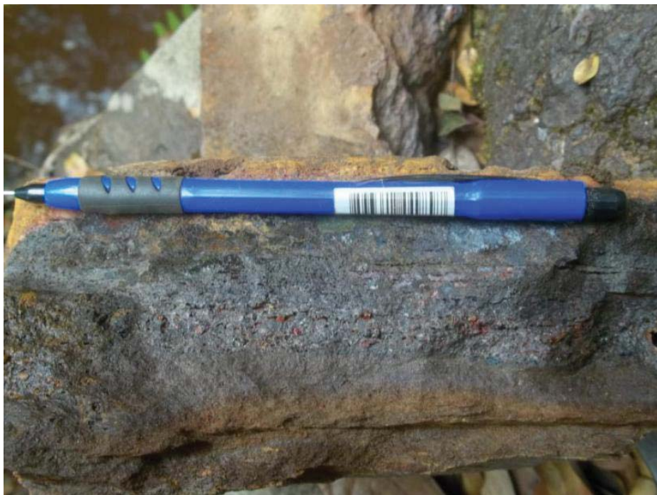
Figura 7.5.2_2 – Detalhe da ocorrência de filito com pirita em amostra coletada na região da Barragem da Usina de Irapé
