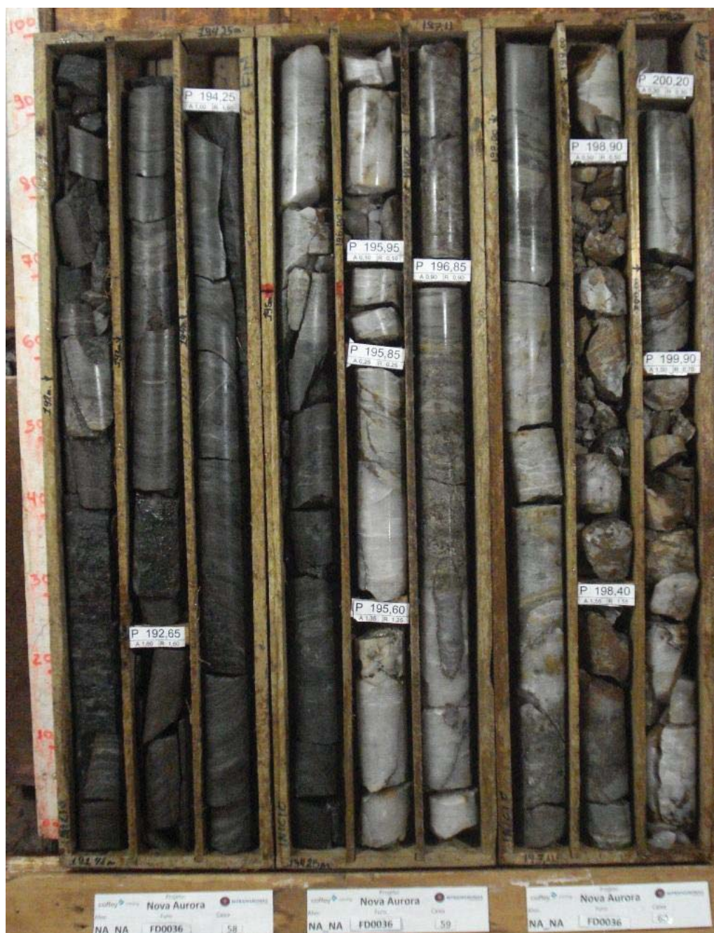
Figura 8.2.2.1_3 – Testemunho de sondagem mostrando o contato de base da formação ferrífera (metadiamicrito ferruginoso) com o metadiamicrito. Detalhe para a ocorrência de veios de quartzo amostrados em todos os furos que interceptaram o contato basal da dobra sul
