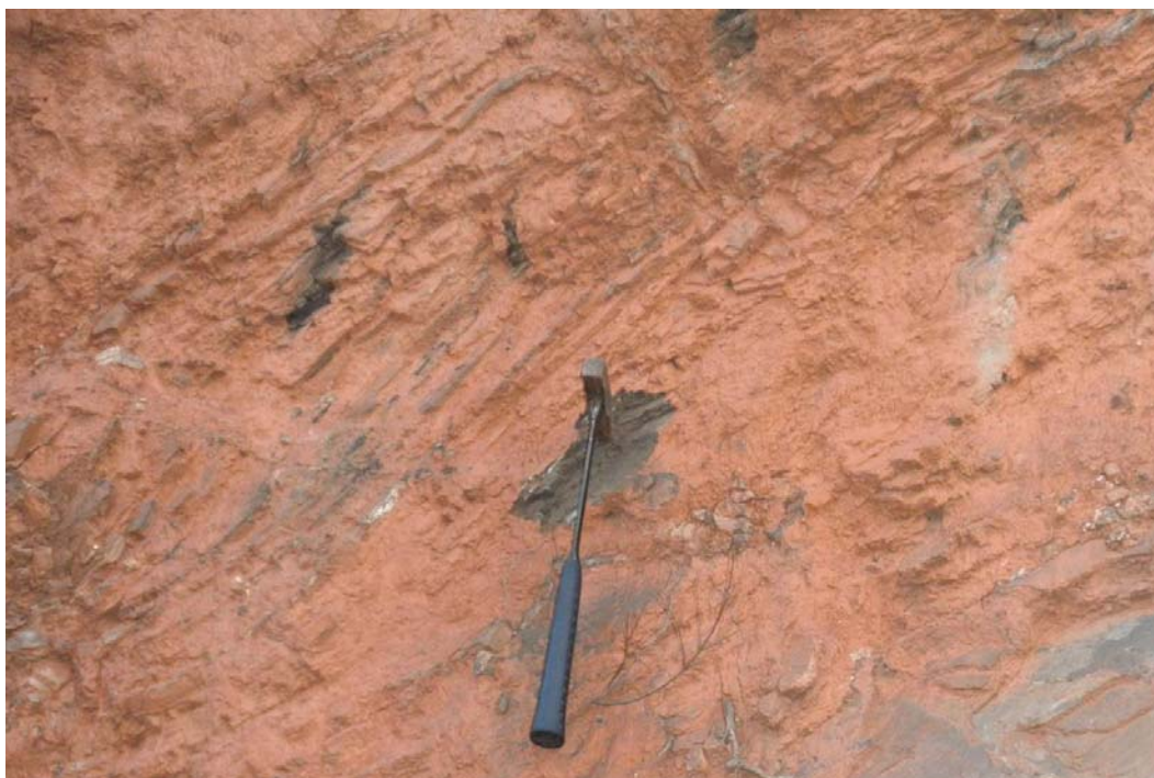
Figura 7.6_6 – Formação ferrífera alterada apresentando enriquecimento em ferro devido a processos supergênicos que causaram a lixiviação da sílica, conferindo uma textura de pastilhas para os minerais de ferro orientados conforme o bandamento original que não foram remobilizados do perfil
