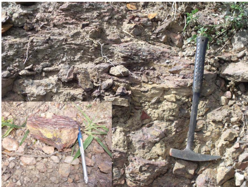
Figura 7.5.3_1 – Afloramento de filito a xisto ferruginoso, com detalhe da rocha no lado inferior esquerdo da imagem
