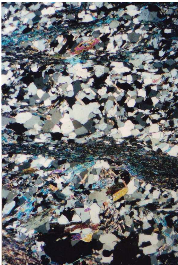
Figura 7.5.2_4 – Aspectos texturais do filito grafitoso vista em lâmina com nicóis cruzados; aumento 25X (ARBÓREA, 1996)
