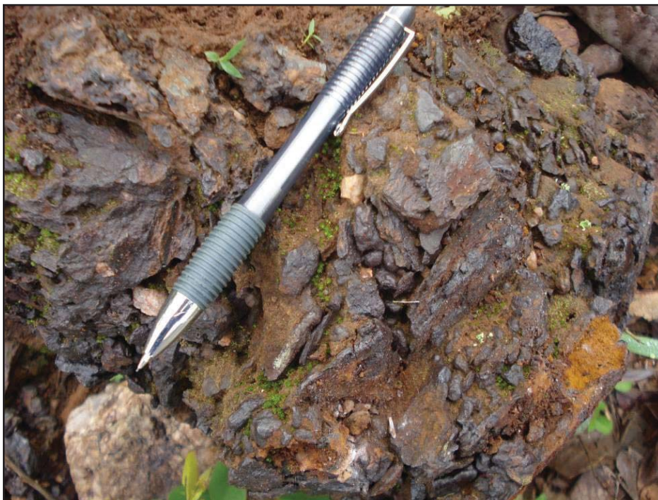
Figura 7.4.1_4 – Bloco da canga hematítica com capeamento de alteração gerado a partir de processos de goethitização e/ou limonitização
