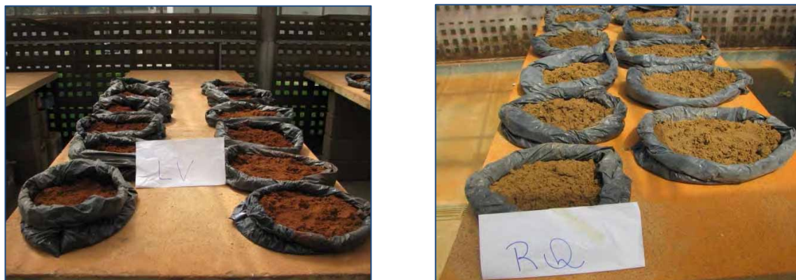
Figura 10. Secagem das amostras de solo LVd e RQ após incubação com calcário e \text{CaCO}_3 + \text{MgCO}_3 , respectivamente.
