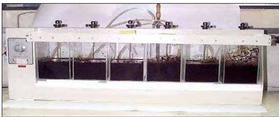
Figura 7. Equipamento utilizado na extração das substâncias húmicas de amostras de turfas coletadas no município de São Simão-SP e no distrito de Taquaral-SP.
