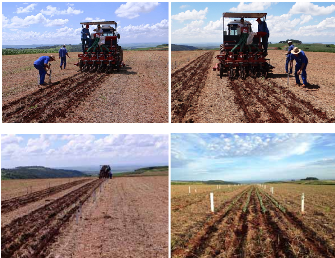
Anexo 1. Semeadora de parcela Semeato, modelo SHP 249, semeando a primeira quinzena de fevereiro, 2013.
