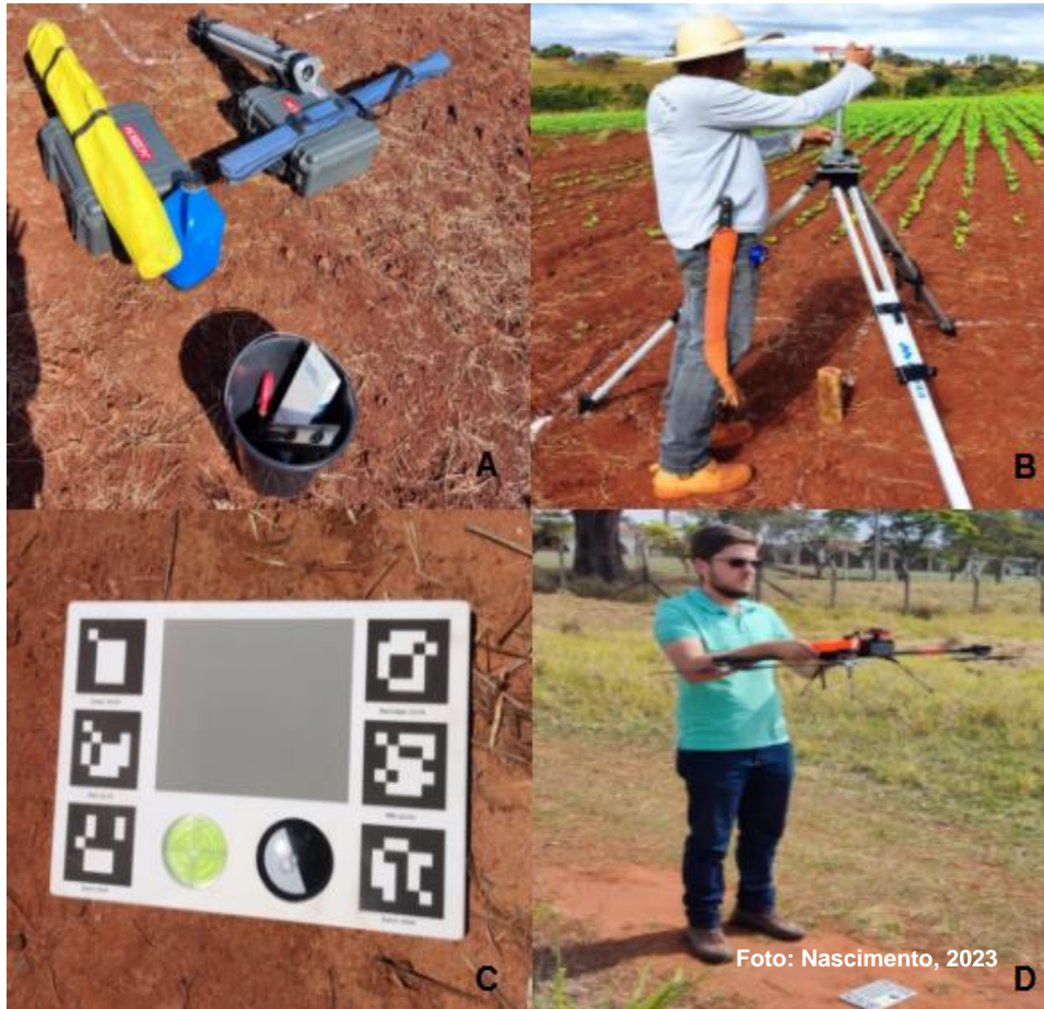
Figura 34 - Etapas de calibração geométrica e radiométrica: Equipamento GNSS RTK (A); coleta e demarcação de pontos de controle (B); painel calibração (C); captura de imagem do painel de calibração (D)
