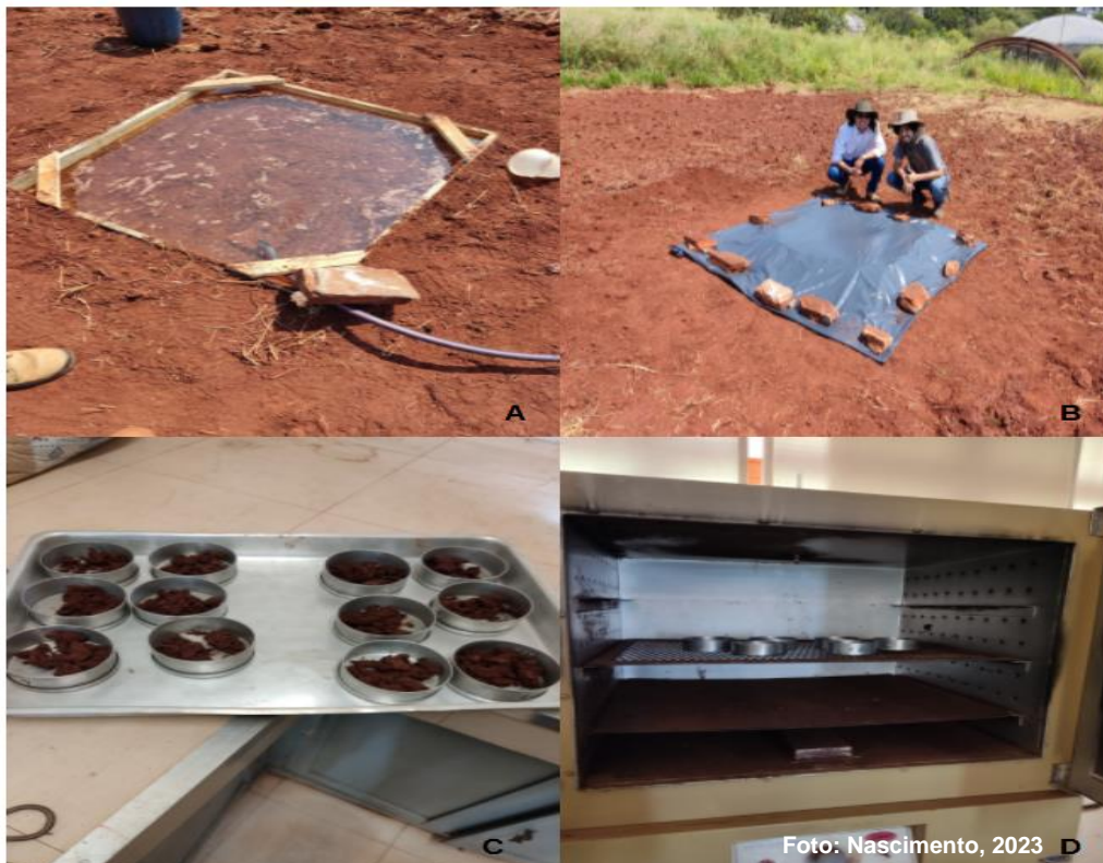
Figura 23 - Etapas do método da bacia de saturação. Inserção e saturação da bacia (A); cobertura da bacia para evitar evaporação (B); material coletado diariamente, após 48 horas de saturação (C); amostras colocadas em estufas por 24 horas a 105\text{ }^{\circ}\text{C} (D)
