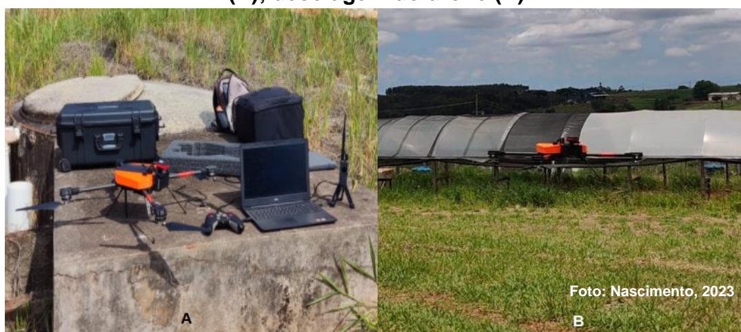
Figura 33 - Aquisição de imagens multiespectrais: Equipamentos necessários (A); decolagem do drone (B)
