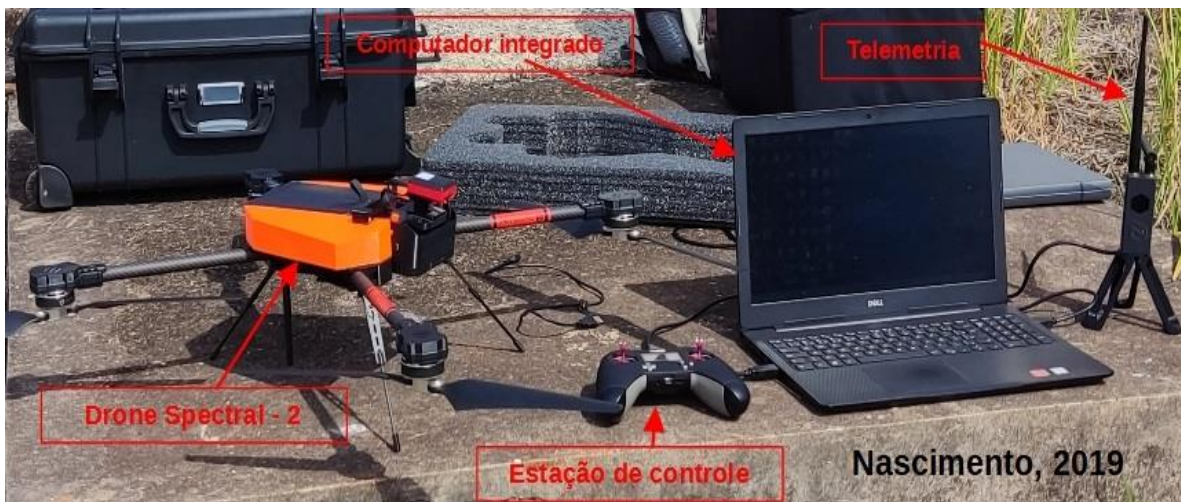
Figura 5 - Componentes básicos de um VANT
