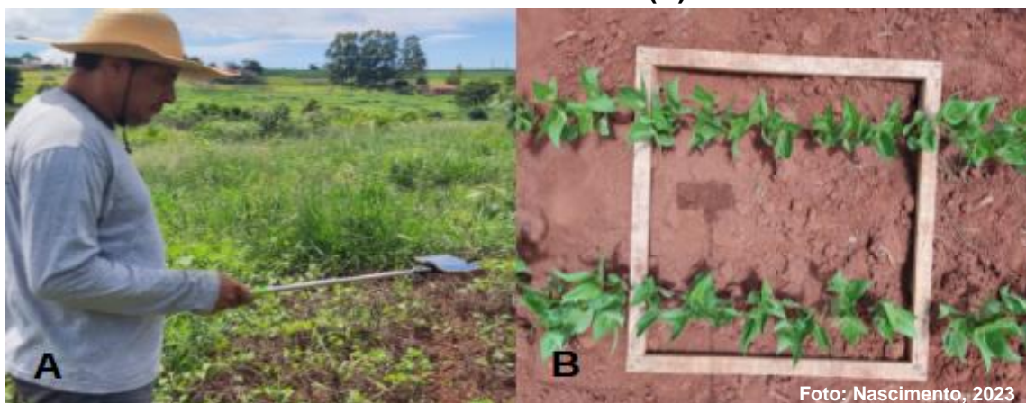
Figura 31 - Captura de imagem usando sensor proximal de câmera de Smartphone acoplado em um bastão selfie (A); imagem digital obtida com a moldura delimitadora (B)
