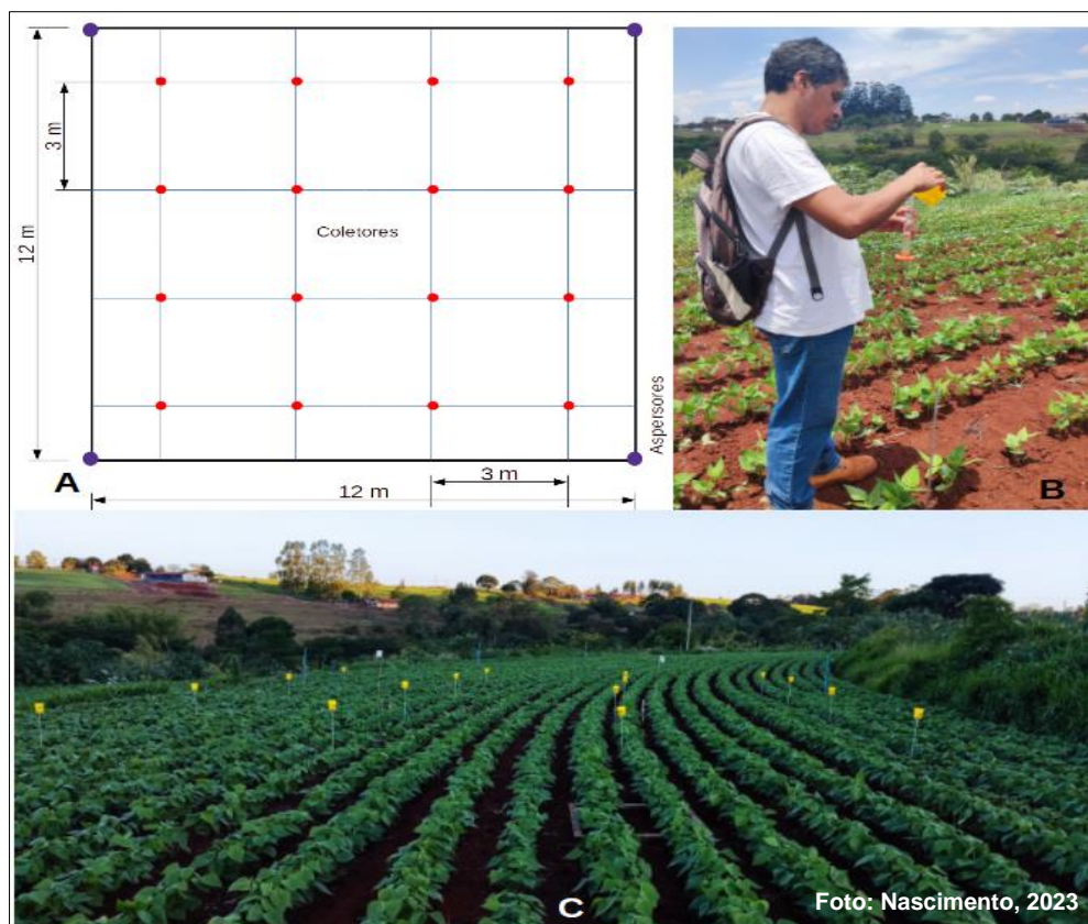
Figura 28 - Croqui de instalação dos coletores (A); Coleta volumétrica usando proveta (B); panorama real da disposição dos coletores (C)
