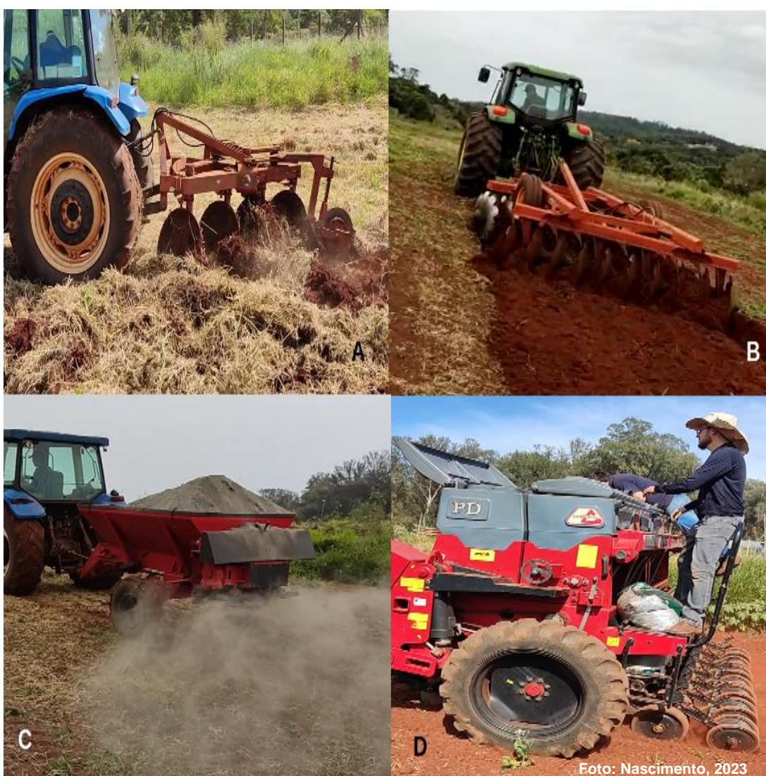
Figura 21 - Procedimentos gerais de preparação do solo da área experimental. Aração com arado de disco reversível (A); gradagem com grade aradora (B); aplicação de calcário dolomítico (C); semearadura e aplicação de adubo com plantadeira Semeato plantio direto (D)
